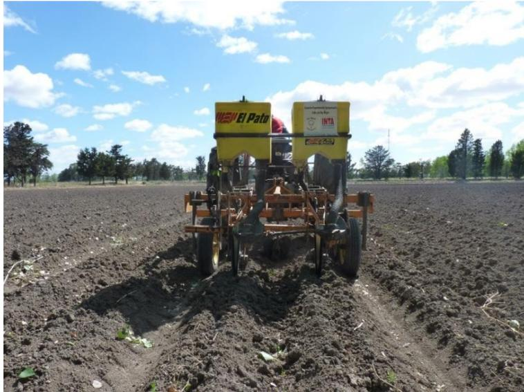
*Figura 15: Siembra mecánica de maíz con formación de surco.*
