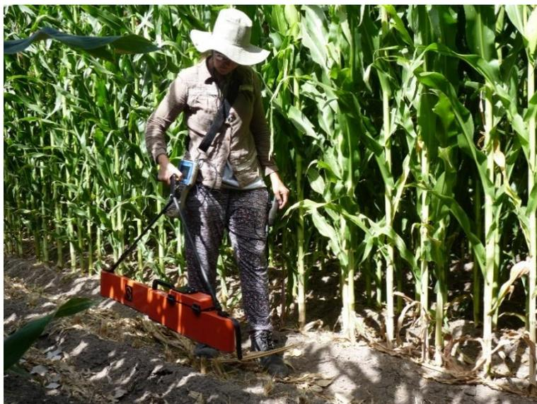
*Figura 12: Medición con la sonda EM38-mk2.*
