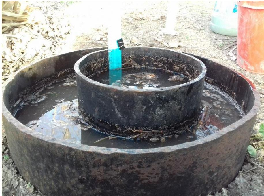
Figura 14: Medición de la infiltración con el método del infiltrómetro tipo doble anillo.
