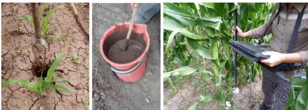
Figura 11: Descripción del proceso de instalación a través de imágenes representativas, y medición con sonda Diviner.
