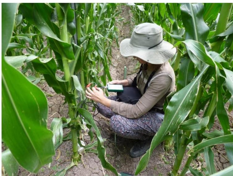
Figura 10: Medición con los sensores Watermark
