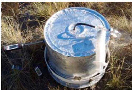
**Figura 2.** Cámara estática cerrada (alto: 20cm y  $\varnothing$ : 35cm) con base fija (10cm, con 5cm enterrados). Forrada en aluminio reflectante. Se muestra termómetro en suelo, ambiente y cámara. Llave de tres vías conectando cámara con jeringa (60 mL) para generación de vacío (-25 psi) y extracción de muestra y vial de tipo Agilent (10 mL). Muestreo de aire pasivo, para calcular flujo de gases de efecto invernadero (GEI) por cromatografía gaseosa.
