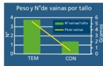
Gráfico 2. Peso y número de vainas por tallo. Evaluación 4/11/11. TEM= tratamiento temprano con una mezcla de carbendazim + dimetoato + giberelina + lambda-diacialotrina + adherente (0,05 lts/ha), CON= testigo sin tratar.
