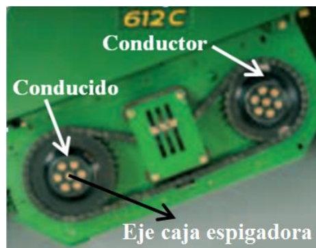
Figura 14. Vista de una caja de transmisión lateral del maicero JD; sin la tapa de cello. (Maquinac, 2015).
