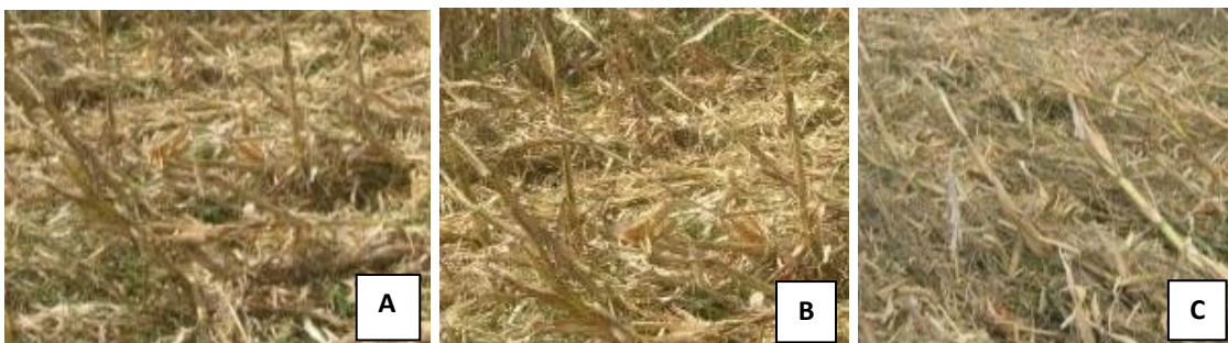
Figura 11: Vistas de la inclinación del rastrojo luego del paso de la cosechadora a distintas velocidades de avance. A. 9 km/h, B. 10 km/h, C. 11,5 km/h.
