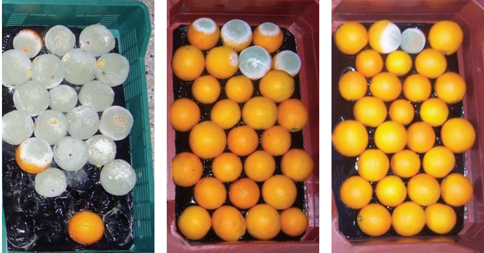
Figura 4. De izquierda a derecha fruta herida previo a la desinfección, luego de desinfectar con oxígeno ionizado y con radiación UVC.
