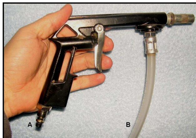
Figura 2: Pico arenador basado en la succión de un sistema venturi. Extremo A conectado a la fuente de presión (cilindro de \text{CO}_2 ) y el caño de succión (B) es introducido en un recipiente con arena.
