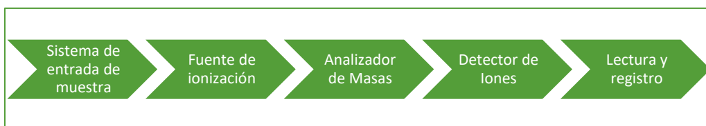
Figura 10. Esquema simplificado de un espectrómetro de masas.
