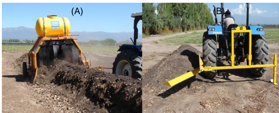
FIGURA 1. Mecanización del volteo de pilas de compostaje. (A) Máquina volteadora (EEA Hilario Ascasubi INTA), (B) Implemento tipo “reja” (EEA Mendoza INTA).
