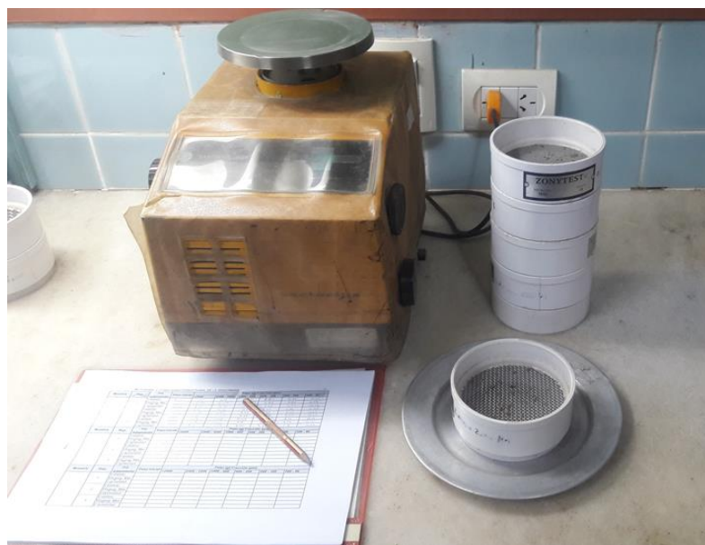
Figura 65: Tamización y clasificación de muestras secas luego de la dispersión, con tamices de >2.000 \mu\text{m} , 2.000-1.000 \mu\text{m} , 1.000-500 \mu\text{m} , 500-200 \mu\text{m} , 200-100 \mu\text{m} y 100-50 \mu\text{m}
