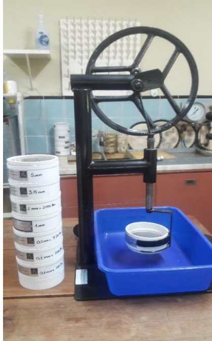
Figura 11: Tamizador FEODOROFF, columna de tamices para clasificación de agregados en seco >2.000 \mu\text{m} , 2.000-1.000 \mu\text{m} , 1.000-500 \mu\text{m} , 500-200 \mu\text{m} , 200-100 \mu\text{m} y 100-50 \mu\text{m} .
