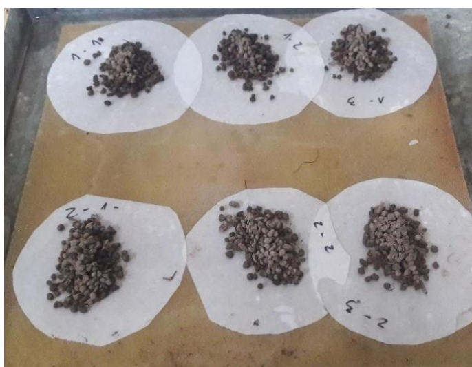
Figura 10: Agregados preparados para humectación lenta con agua por capilaridad (DMPc).
