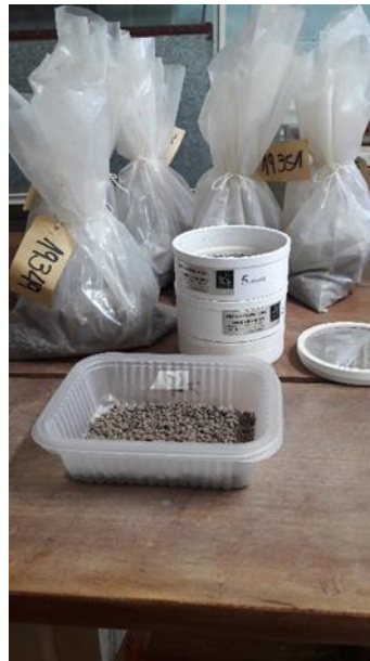
Figura 61: Muestra de 10 g de agregados de suelo tamizada en de tamiz de 5 mm
