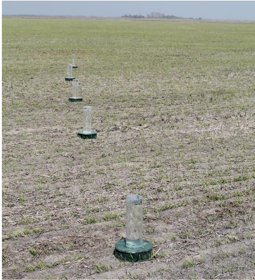
Figura 57: Determinación de la Infiltración con Infiltrómetros de anillo simple, en lotes de Arroz sobre la serie de suelos Chequin.
