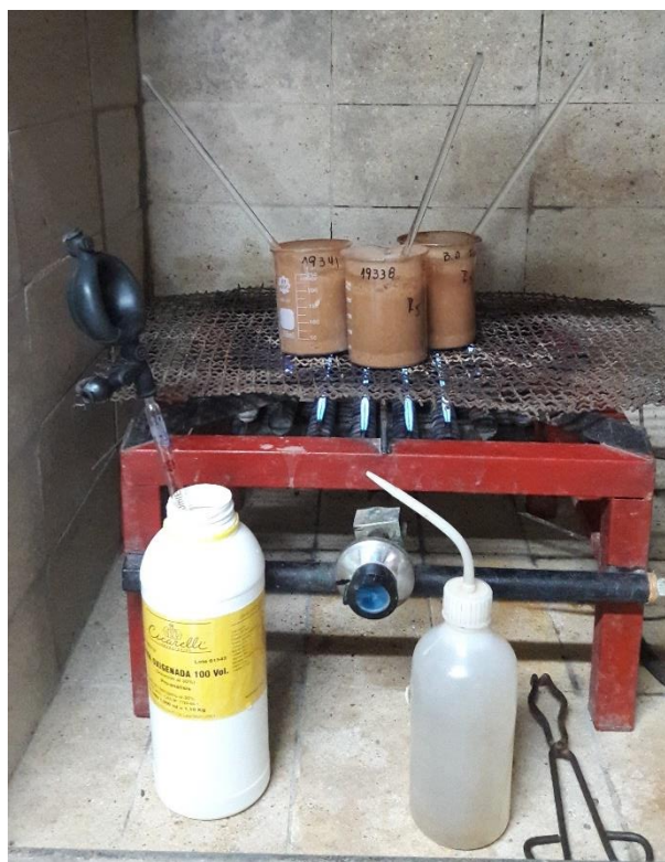
Figura 47: Destrucción de la materia orgánica mediante la digestión con agua oxigenada ( H_2O_2 ) y calor constante
