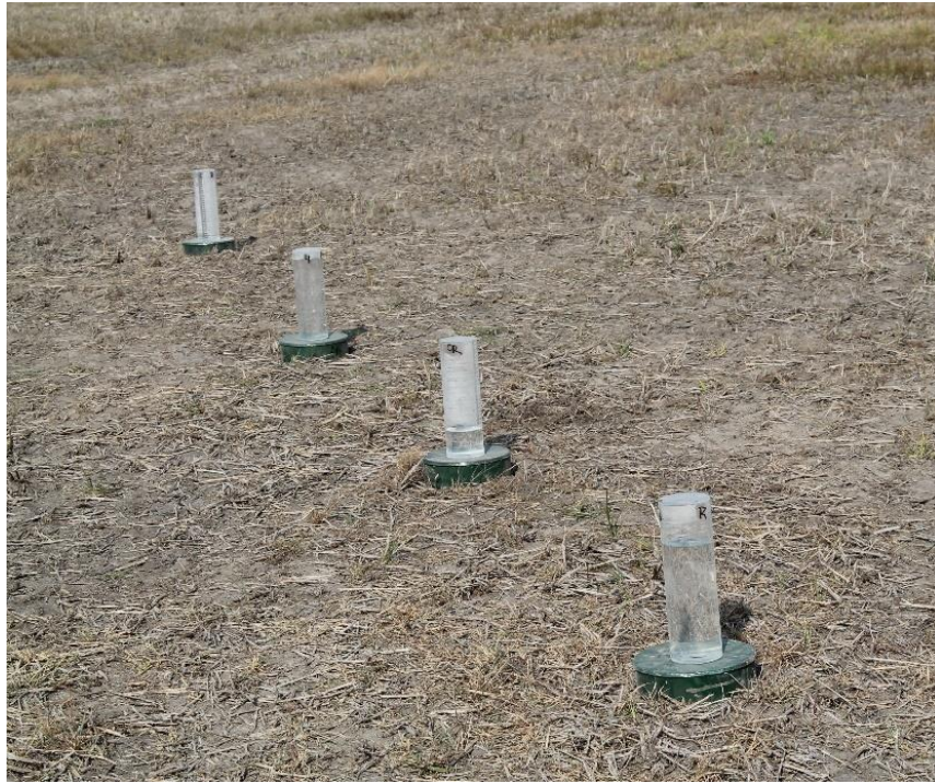
Figura 58: Determinación de la Infiltración con Infiltrómetros de anillo simple, en lotes de Arroz sobre la serie de suelos Timbó Paso.
