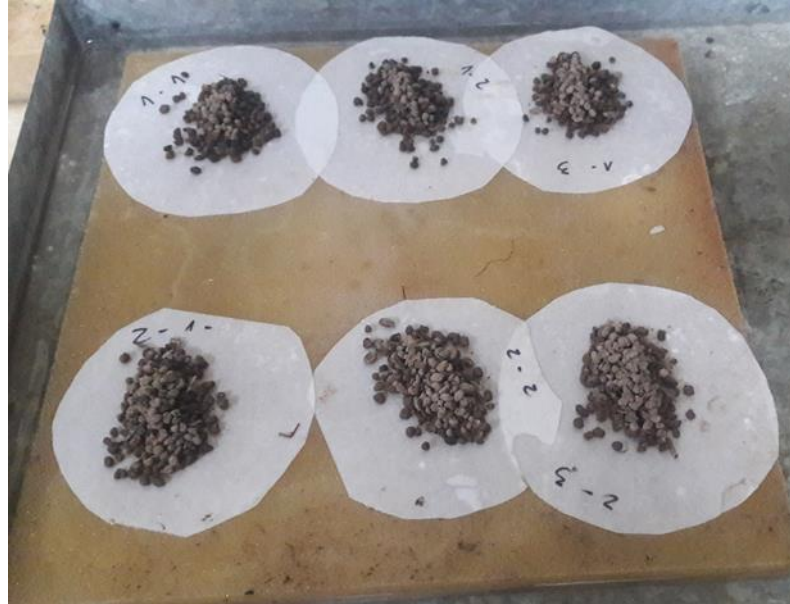
Figura 64: Muestras de 10 g de agregados en bandeja de humectación lenta con agua por capilaridad.
