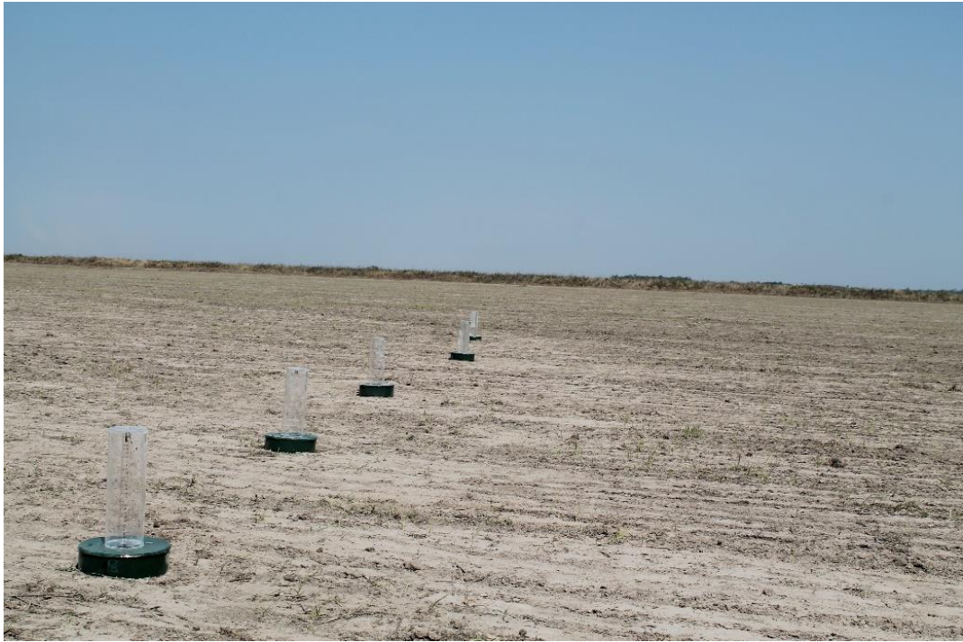
Figura 55: Determinación de la Infiltración con Infiltrómetros de anillo simple, en lotes de Arroz sobre la serie de suelos Torres.
