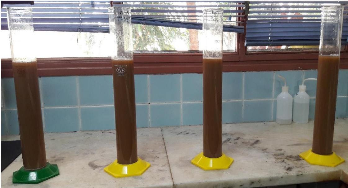
Figura 50: Determinación de la densidad mediante densímetro, colocado dentro de probetas de vidrio
