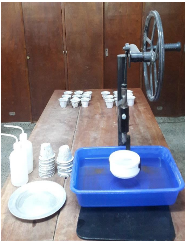
Figura 63: Disgregación mecánica de agregados mediante el tamizador FEODOROFF.
