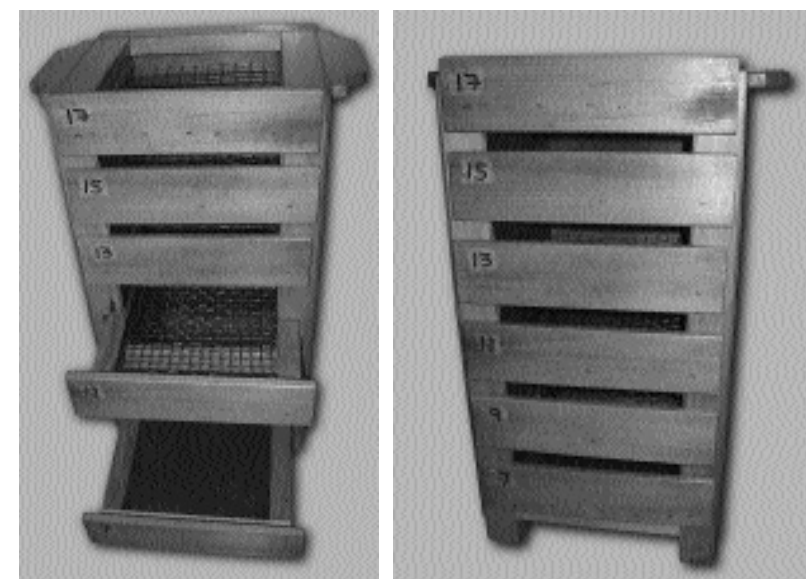
Figura 2.6: Juego de tamices de madera, para tamañar bayas de uva
