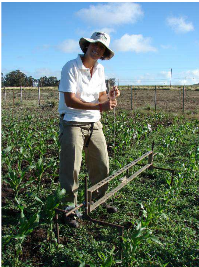
Figura 10. Bastidor de 1,5 m con perforaciones cada 5 cm utilizado para la determinación de cobertura de malezas en parcelas de maíz y girasol con y sin pastoreo de ñandúes (diseño: Maceira y Verona, 1980). Verano 2008-2009. Balcarce, Buenos Aires, Argentina.
