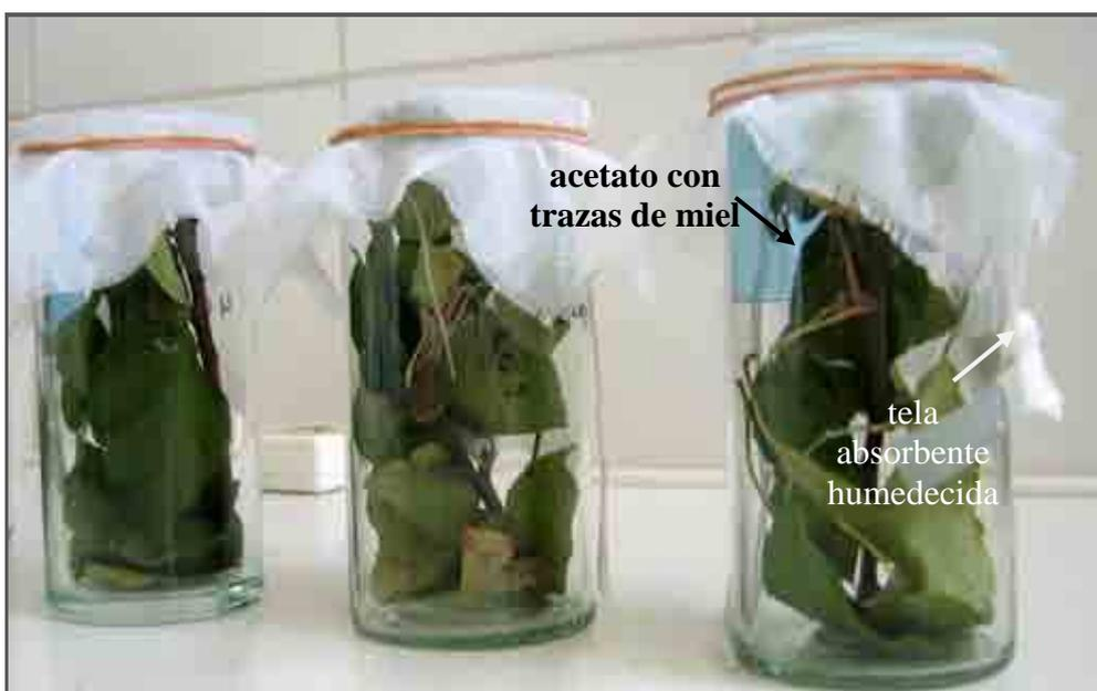
**Figura 4.7.** Dispositivos usados en las pruebas de persistencia de la acción de los insecticidas en los adultos de *M. ridens*.
