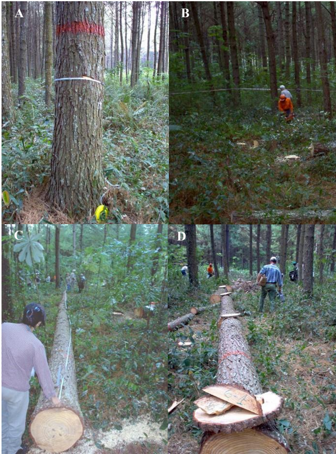
Figura 3-1. Actividades de muestreo de biomasa en campo, A) selección de árboles, B) apeo de árboles, C) cubicación de fuste y, D) trozado de fuste.
