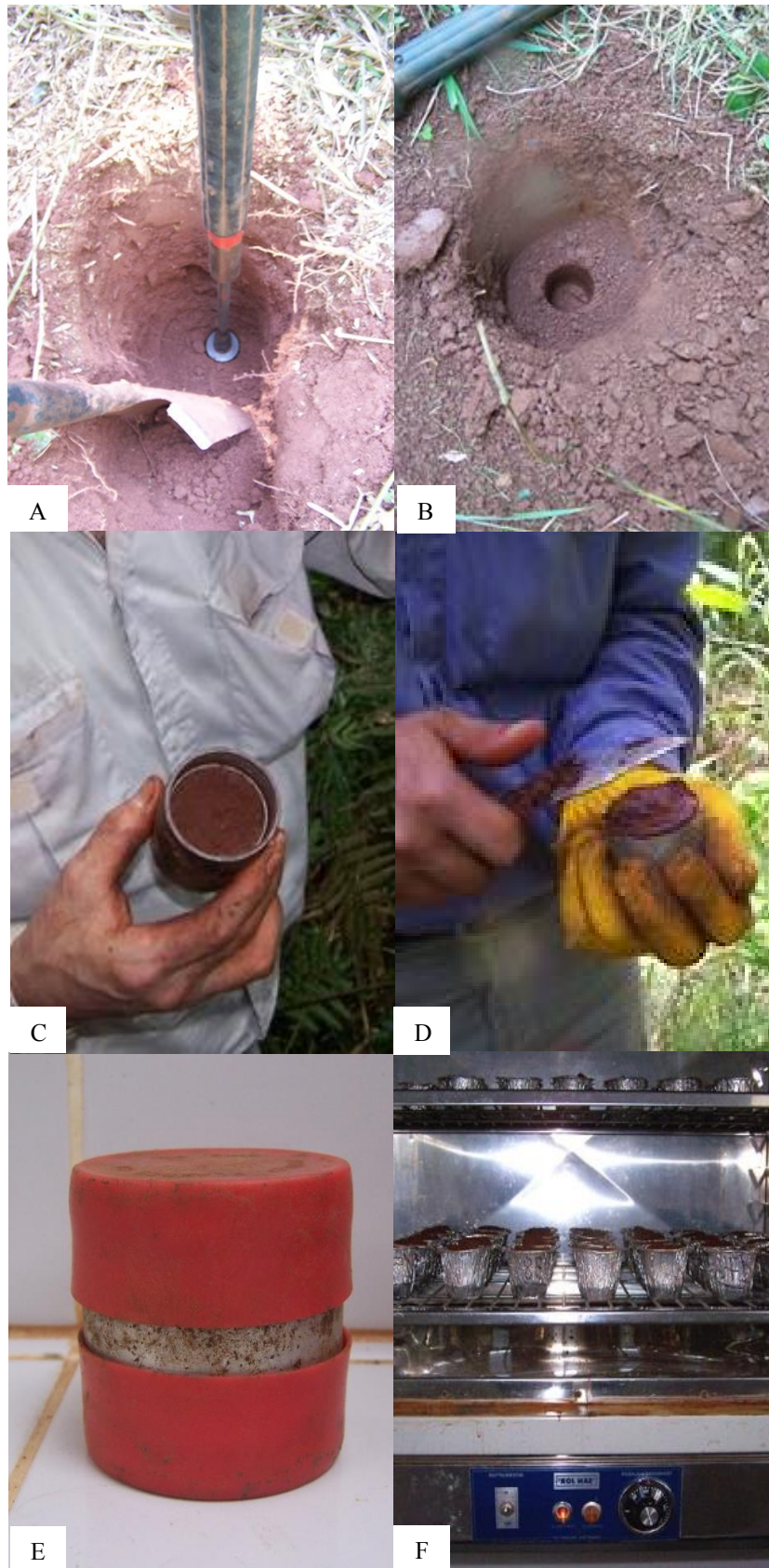
Figura 2-8. Muestreo de la densidad aparente en suelos rojos, A) martillo extractor de muestras, B) orificio de donde se extrajo la muestra, C) extracción del cabezal del martillo junto a la muestra, D) enrasado de la muestra, E) preservación de la muestra para su traslado y, F) secado de las muestra en estufa.
