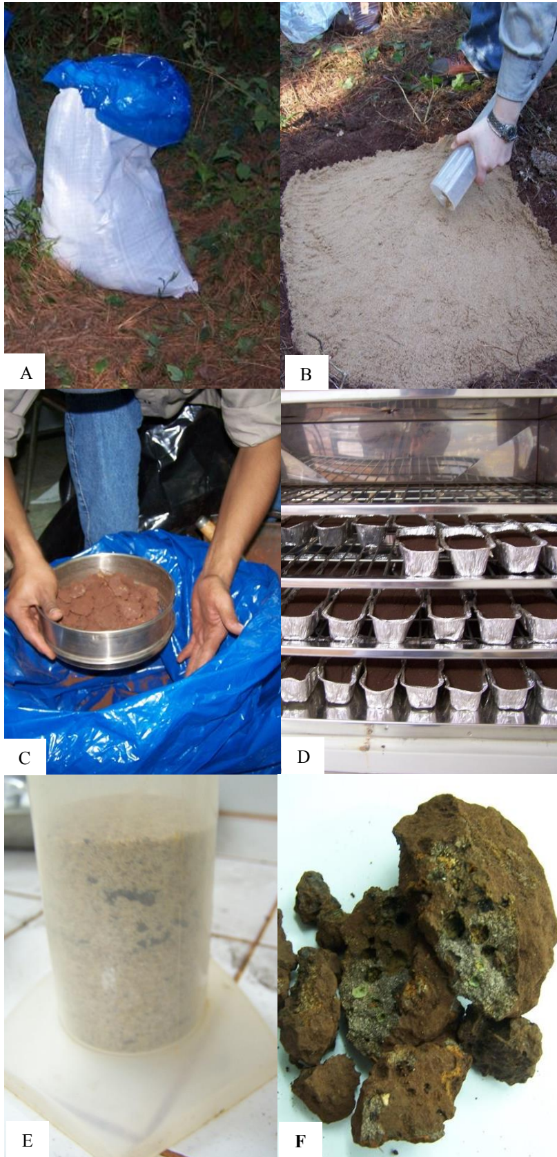
Figura 2-9. Muestreo de la densidad aparente en suelos pedregosos, A) recolección del material del pozo, B) cubicación del pozo, C) tamizado del material del pozo, D) secado de la fracción fina, E) cubicación de las piedras y, F) fracción gruesa del pozo.
