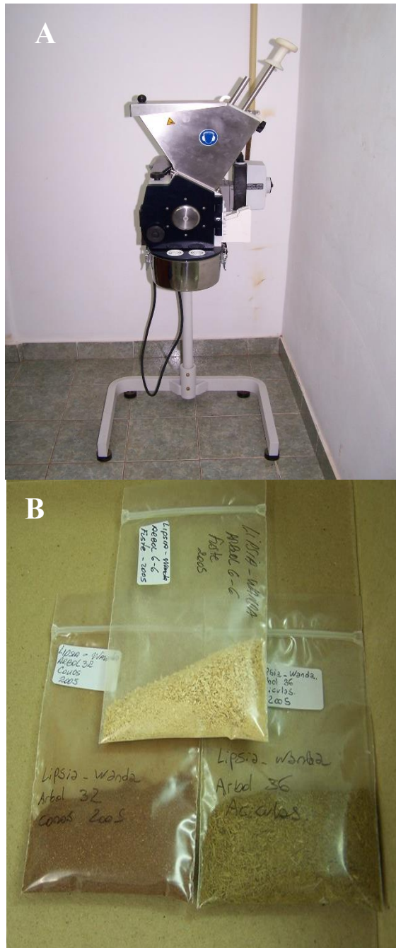
Figura 4-1. Molienda de muestras, A) Molino procesador de muestras y, B) bolsas con muestras molidas para la determinación de la concentración de nutrientes.
