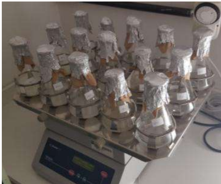
Fig. 19: Imagen del Shaker, proceso de agitado de los fitosanitarios y cepa de Beauveria bassiana .
