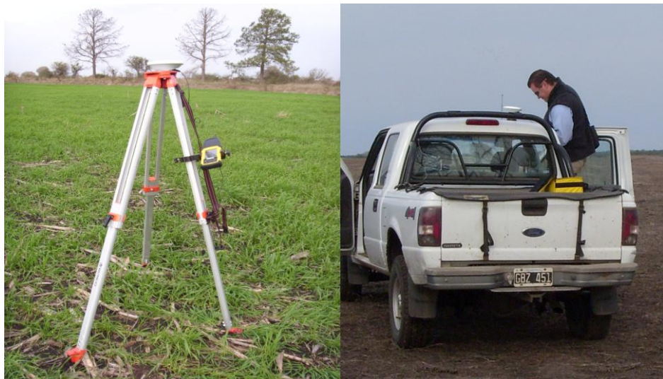
Fotos 2 y 3. GPS para medición de Altimetría: Módulo estacionario (izquierda), instalación del módulo móvil sobre el techo de la camioneta (derecha)
