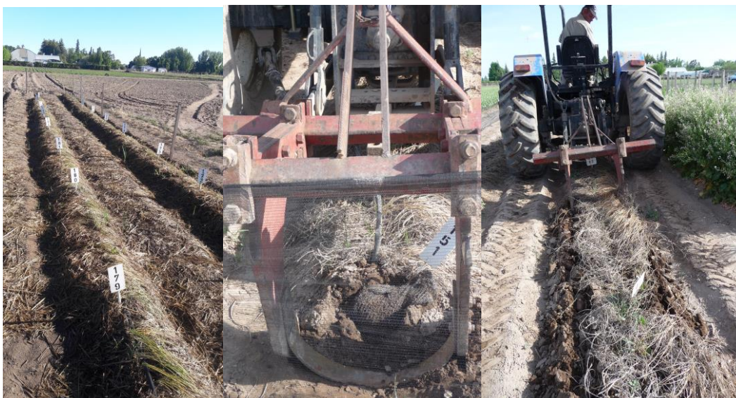
Figura 22 Surco listo para cosecha. Cosecha semi mecanizada, con desplantador de estacar. Detalle de la cuchilla pasando por debajo de la manta de plantación.
