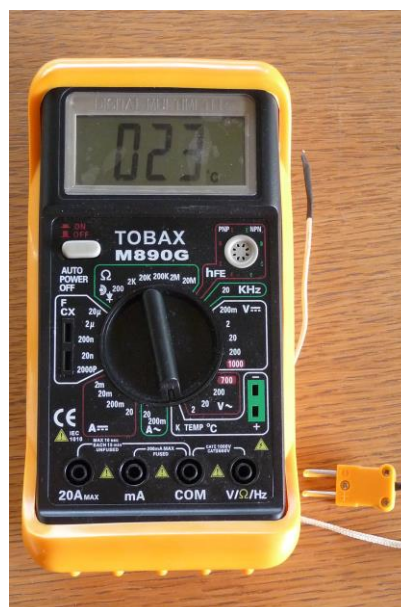
Figura 21 Medidor digital de electricidad con sensor de temperatura
