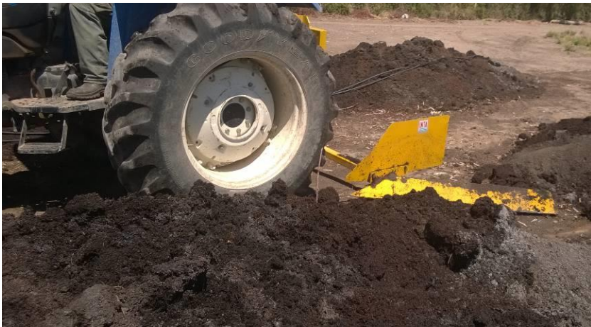
Figura 5. Detalles de la herramienta utilizada para esparcir el compost y luego rearmar las pilas para su volteo.
