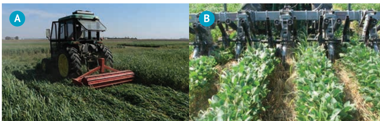
Foto 1. (A). Rolofaca para secado de cultivo de cobertura (CC). Rolado de triticale como CC en la EEA INTA Marcos Juárez. (B) Cultivador para desmalezamiento en post-emergencia del cultivo estival. Desmalezamiento de soja sobre tritricale como CC. (Modelo de cultivador, no es el de la EEA Marcos Juárez. En la EEA hay un prototipo similar).
