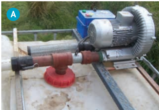
Foto 3. Vista superior del tanque para producir té de compost: A) bomba aireadora, B) producto final.
