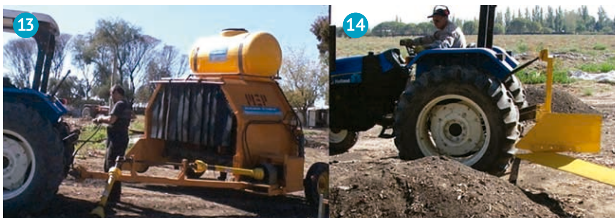
Fotos 13 y 14. (13) Volteadora de compost (prototipo desarrollado en INTA EEA Ascasubi) y (14) reja removedora de compost (prototipo desarrollados en INTA EEA Mendoza).
