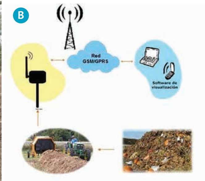
Foto 2. A) Sensor instalado en pila de compost. B) Sistema telemetría transmisión de indicadores de proceso de compostaje.
