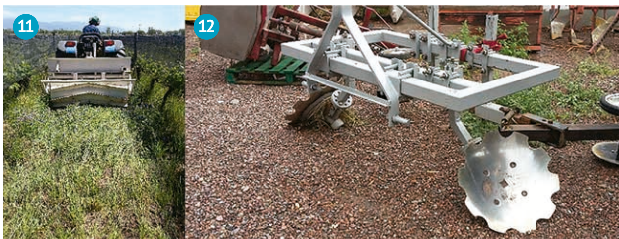
Fotos 11 y 12. (11) Rodillo para volteo (o rolado) de cultivos de cobertura anuales y (12) prototipo de bajo costo para el desmalezado intercepa (mecánico) de la línea de plantas de vid.
