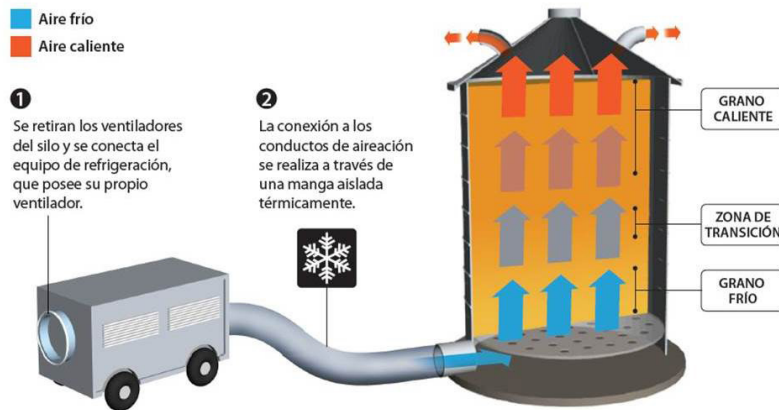
Figura 1. Esquema de conexión y funcionamiento del equipo de refrigeración de granos. Fuente: adaptado de Navarro y Noyes (2002).
