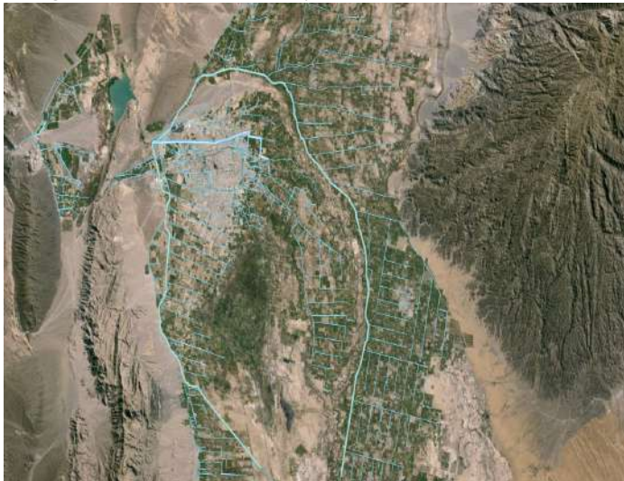
Fotografía N°2 La imagen muestra el sistema de riego formado por la red de canales, para el Valle de Tulum, donde se ubican la mayor zona agrícola de la provincia y la mayor concentración de la población.
