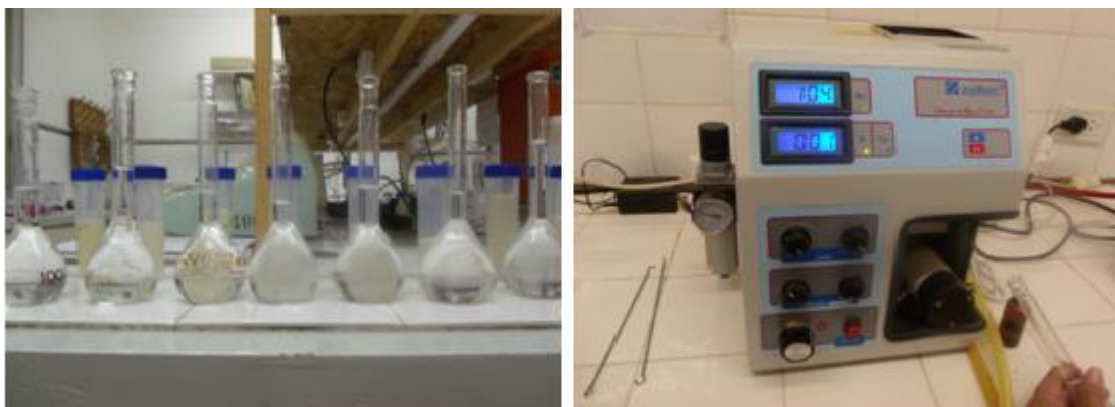
Figura 14: foto a la (izquierda) matraz de 100 mililitros aforado con muestra y a la (derecha) medición por el fotometro de llama.
