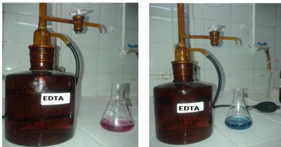
Figura 15: foto a la (izquierda) alícuota del extracto, buffer e indicador y la (derecha) titulación con EDTA hasta el viraje del indicador a azul.
