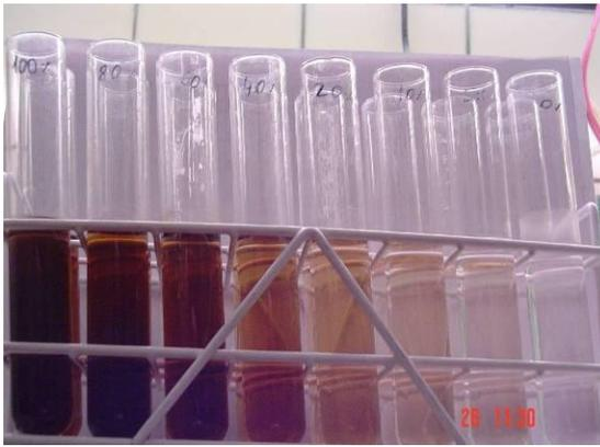
**Figura 28: Preparación de las diluciones de efluente de cerdo para ensayo con *D. magna***
