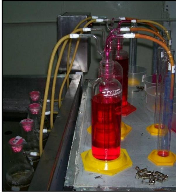
**Figura 23: Reactores en batch por el método de desplazamiento**
