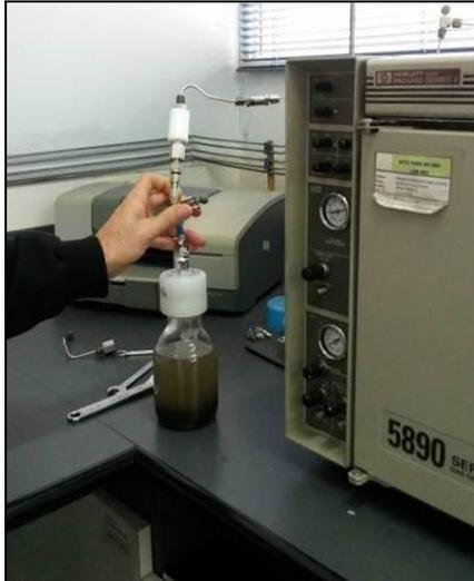
**Figura 27: Medición de la calidad de biogás, mediante cromatografía gaseosa**
