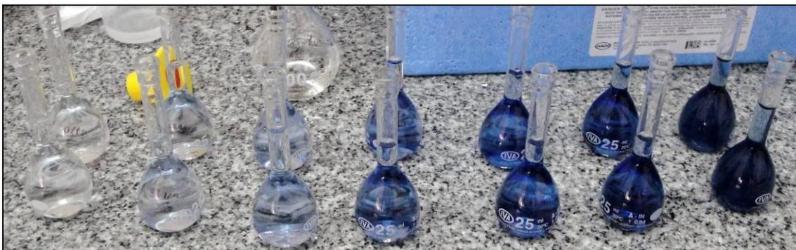
**Figura 19: Curva de calibración preparada para la determinación de ortofosfato**
