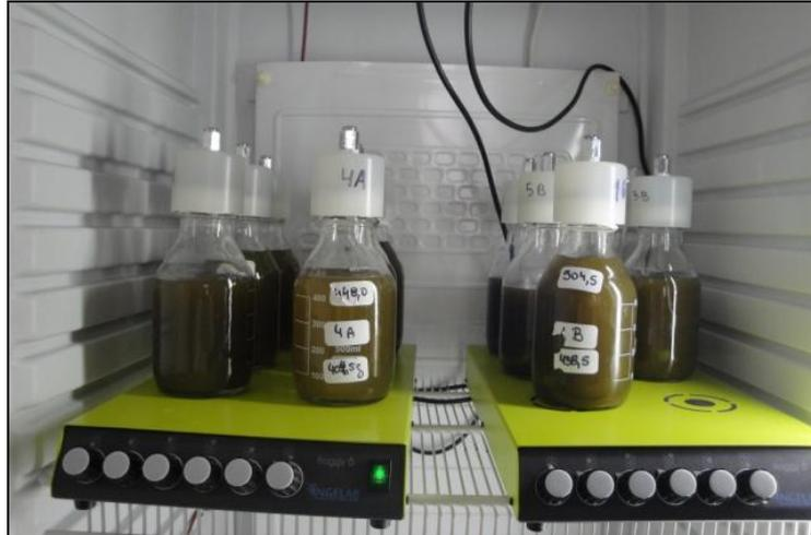
**Figura 25: Reactores en batch utilizado para el ensayo de AME y biodegradabilidad**
