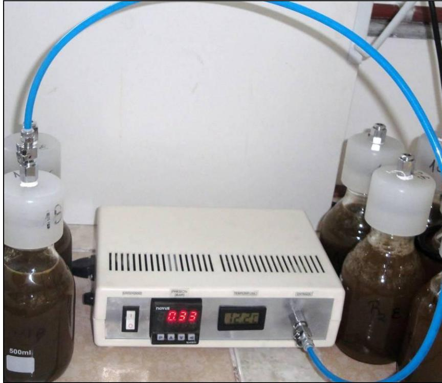
**Figura 26: Medición del volumen de gas, mediante equipo manométrico**
