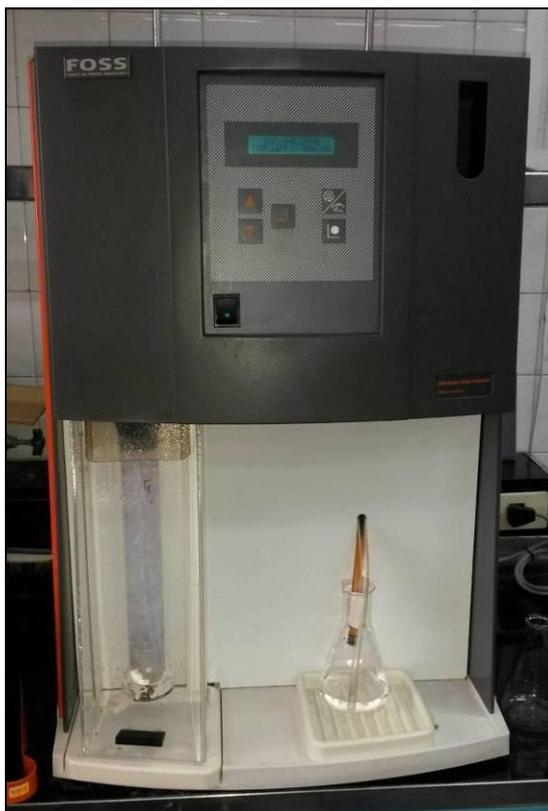
**Figura 20: Equipo de destilación para la determinación de NTK y  $\text{NH}_4^+$**
