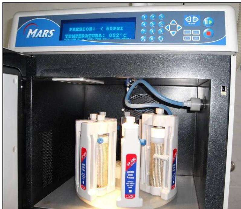
**Figura 18: Equipo de microondas, para digestión ácida**
