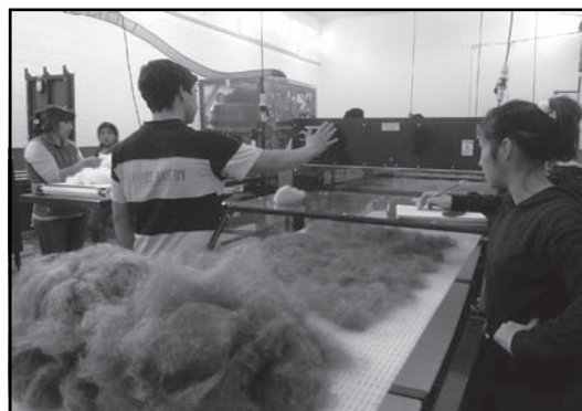
■ Foto 2: Jóvenes capacitándose para la separación de fibras finas y gruesas en la descerchadora de Minimills en Chos Malal.
