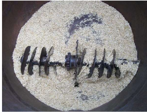
Foto del fondo del tambor con el tornillo dosificador de semilla
