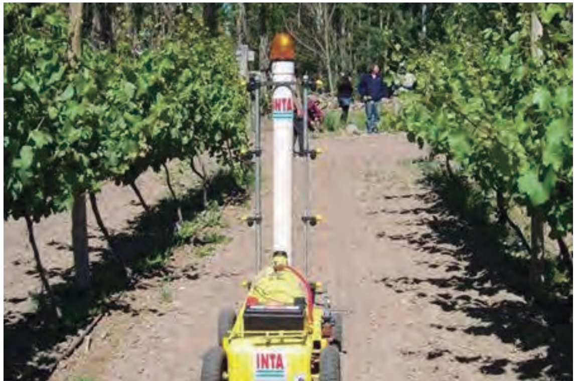
Robot Trakur prueba de campo para prácticas en sanidad vegetal (2012)
