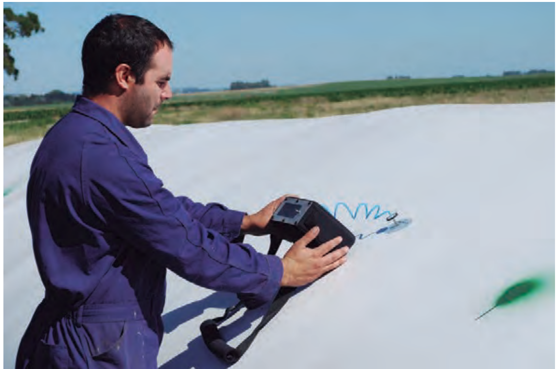
Medición de CO2 y humedad en silo bolsa, Balcarce (2010)
