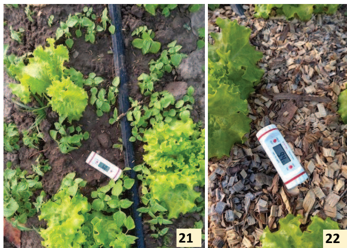
Imágenes 21 y 22: Medición de la temperatura del suelo a 5 cm de profundidad, testigo 6.0 °C y con mulching 9.4 °C, en el mes de mayo 2022.
