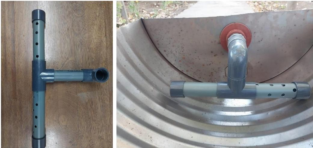
Figura 11. Caída de agua sumergida al segundo tacho.
