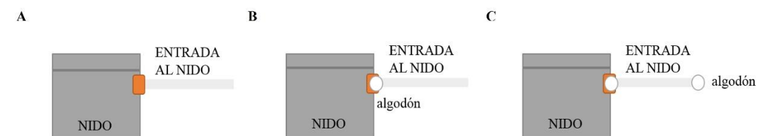
Figura 14. Metodología para la colecta de alimento proteico en nidos de Vespula germanica . (A) Esquema en vista lateral de la caja experimental y la manguera que permite el ingreso y egreso de los individuos al nido. (B) Para capturar las avispas que ingresan al nido se bloqueó el orificio interno de la manguera. (C) Luego de un minuto, se bloqueó el extremo libre de la manguera. Esta manguera fue retirada y reemplazada por otra similar.
