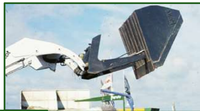
Figura 17-18 El movimiento de la parte posterior del balde, es más conveniente que el descenso del frente.
