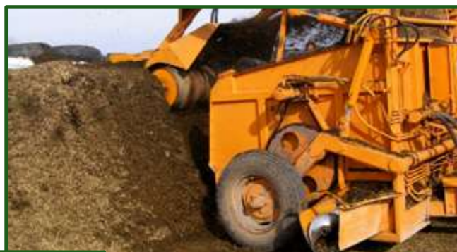
Figura 17-21 Fresa adosada a una pala cargadora o a una batea para suministro.
