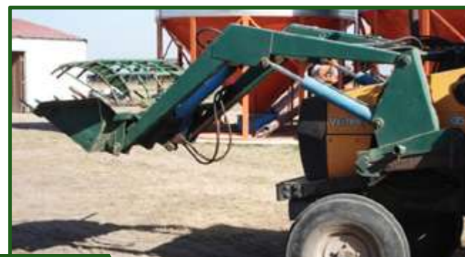
Figura 17-16 La gran distancia del balde al eje del tractor aumenta el brazo de palanca e incrementa la fatiga del tren delantero,
