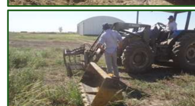
Figura 17-19 Aditamento específico para la extracción de silaje acoplado a un cargador frontal.
