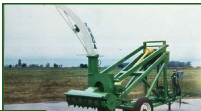
Figura 17-23 Fresa de extracción y de soplado a un acoplado.
