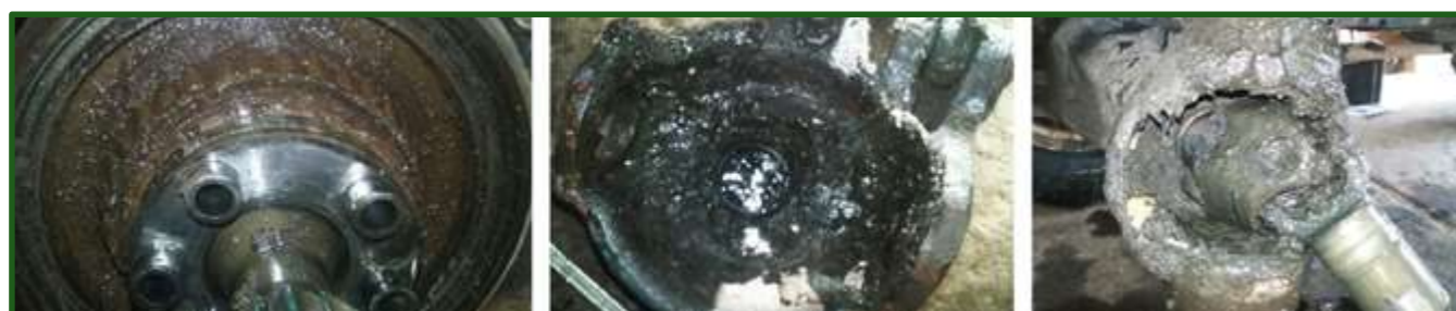
Figura 17-31 Ingreso de agua por retenes rotos, se oxidan los rodamientos y no hay grasa que arregle la negligencia, de no haber realizado la reparación a tiempo.
