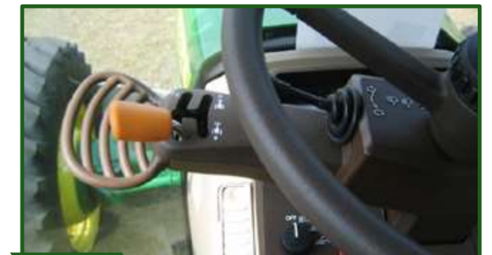
Figura 17-20 El reversor de marchas alivia la fatiga en la operación y disminuye el desgaste del tractor.
