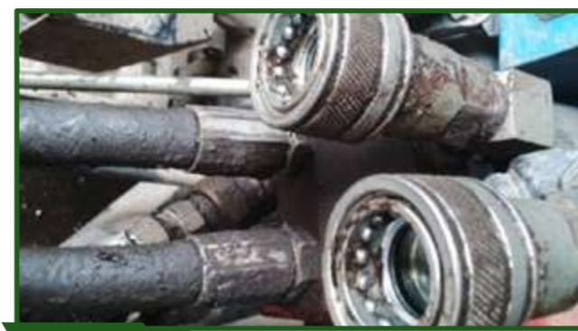
Figura 17-33 Falta de limpieza de los acoples hidráulicos que comprometen la integridad del sistema.
