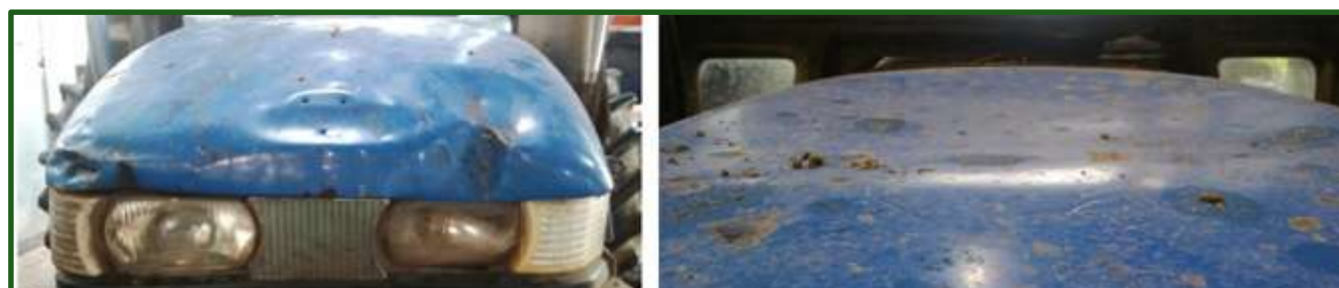
Figura 17-29 Capot del motor hundido, por rollo caído del pinche frontal, golpes al mixer y otras herramientas con la trompa del tractor, patinamiento y frenado contra los carros.
