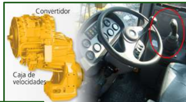
Figura 17-15 A) Transmisión con convertidor de par hidráulico, conectado a una caja de velocidades con alta y baja mecánica. Observar el doble acople para transmisión delantera y trasera. B) Sistema de comando de la transmisión por Joystick.
