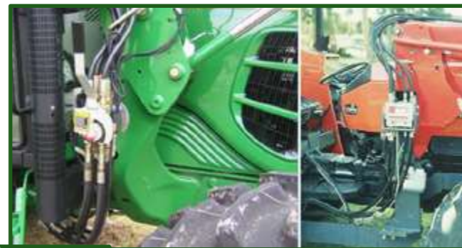
Figura 17-17 Acople rápido de sistemas hidráulicos, para liberar el tractor.
