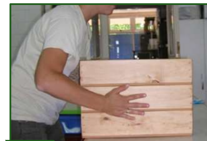
Figura 16-46 Utilización del separador de partículas "Penn State". Todos los movimientos deben ser horizontales y energéticos con un desplazamiento de entre 17 y 20 cm.
