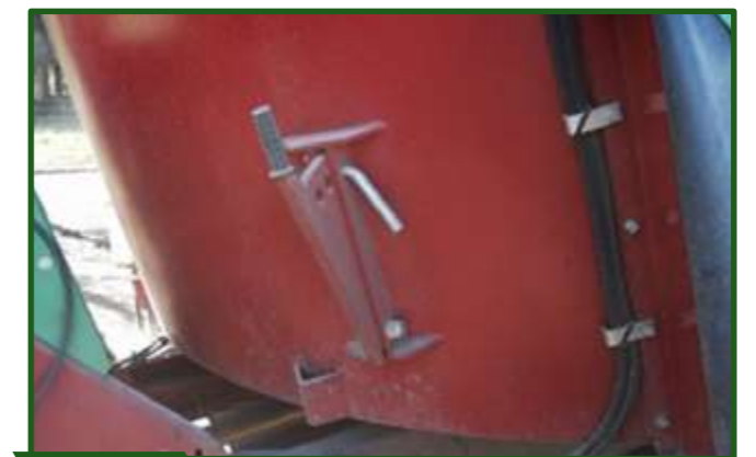
Figura 16-4 Vista exterior e interior de los frenos que determinan el grado de cortado o desmenuzamiento de la fibra incorporada a la ración. Estas trabas, al introducirse en mayor o menor medida dentro de las bateas, van frenando con diferente intensidad al forraje.
