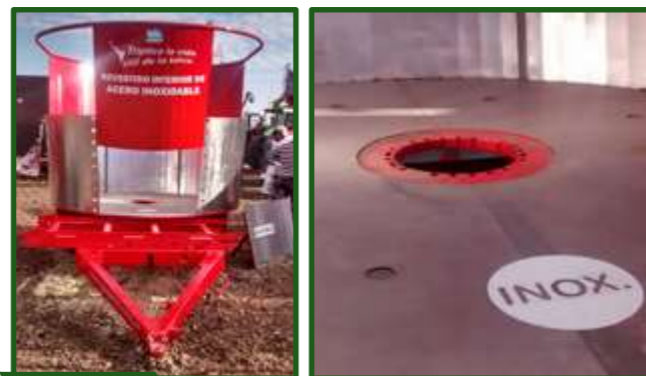
Figura 16-40 Mixer vertical con piso y mitad de altura de tolva revestido en acero inoxidable.
