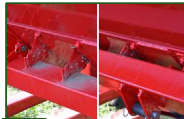
Figura 16-24 Destalle de mixer horizontal trozador de fibra con sistema de contracuchillas retraíbles, desactivadas (izquierda) y ubicadas en el interior de la batea activadas para trozar (derecha).
