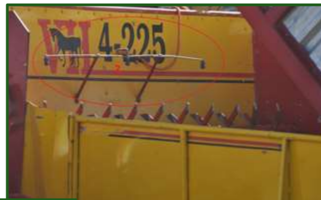
Figura 15-8 Detalle del sistema de inoculación en una máquina embolsadora. Se observa el tanque depósito (1) y la línea hidráulica con las pastillas de distribución sobre las bateas (2).
