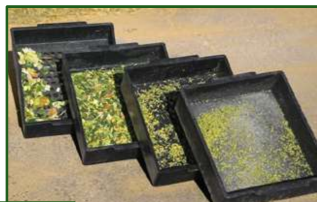
Figura 16-43 Separador de Partículas "Penn State", para evaluar tamaños y distribución de partículas en henos, silajes y dietas TMR.
