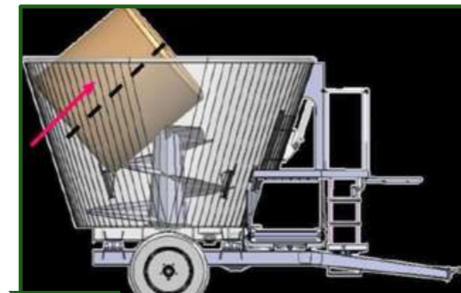
Figura 16-2 Mixer con sistema de rotor vertical.
