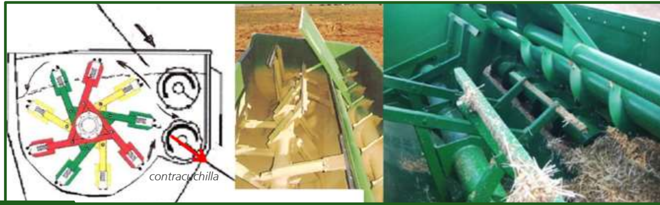
Figura 16-26 Mixer a paletas con rotor secuencia y sinfines laterales.
