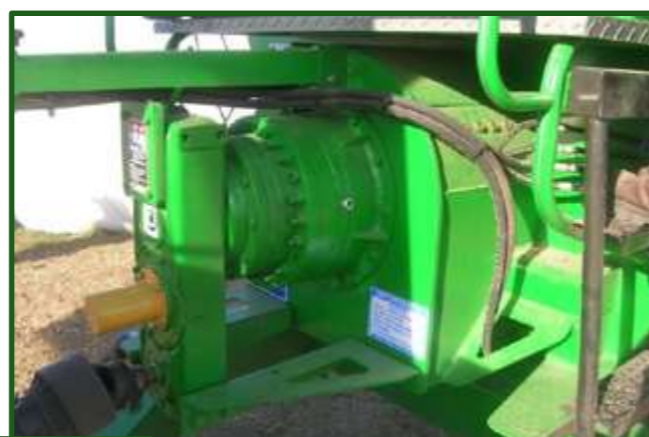
Figura 16-22 Detalle de caja con dos entradas, la inferior es para activar el funcionamiento del mixer y la superior (cubierta con un capuchón gris) de uso eventual, para invertir el giro de los sinfines en caso de trancado.
