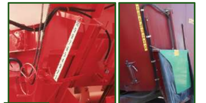
Figura 16-38 Trampas de metal para prevenir accidentes por la ingestión de cuerpos metálicos en la ración.
