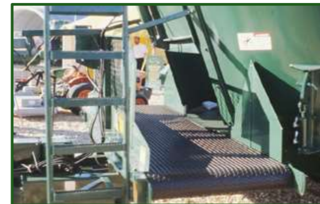
Figura 16-36 Sistema de descarga frontal con cinta de caucho que permite entregar el forraje a ambos lados del acoplado.
