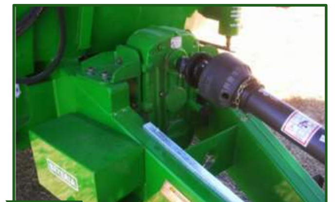
Figura 16-5 Detalle de caja reductora de entrada.
