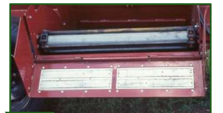
Figura 16-39 Sistema de descarga con trampas de metal para prevenir accidentes por la ingestión de cuerpos metálicos en la ración.
