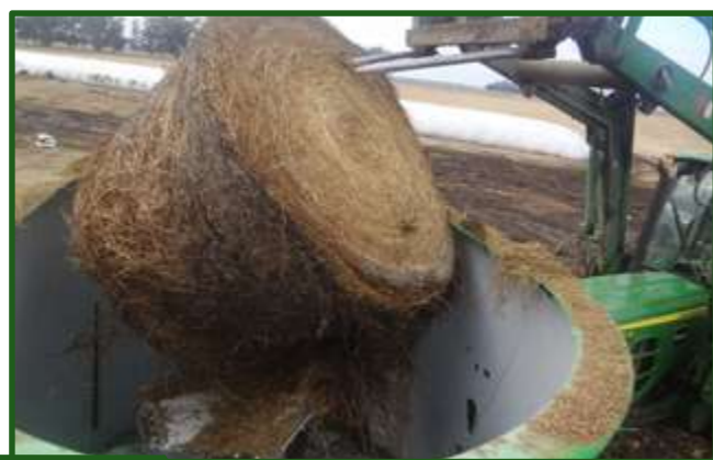
Figura 16-12 El primer paso es colocar el rollo apoyando la cara curva contra el rotor, nunca la cara plana.
