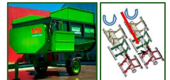
Figura 16-30 Mixer con sistema de aspas radiales en posición angular
