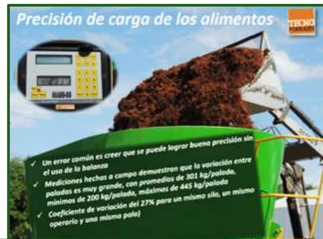
Figura 16-31 Las balanzas facilitan el control de carga y descarga, mejorando el nivel de eficiencia de la alimentación (Fuente: Fernando Bargo, comunicación personal).
