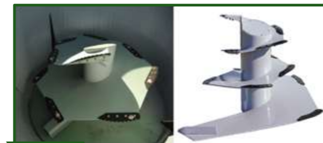
Figura 16-3 Vista interior de la batea de mixer vertical con sinfín tronco cónico con cuchillas y contracuchillas distribuidas en la periferia inferior.
