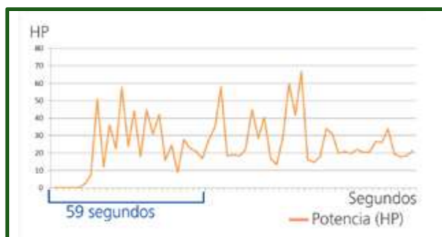
Figura 16-15 Potencia consumida en el mismo ensayo, la cual se detalla en otra escala más visible, especialmente en los segundos iniciales de mayor demanda, generándose un pico a los 40 segundos iniciales de casi 70 hp, por tener las trabas colocadas desde el inicio.
