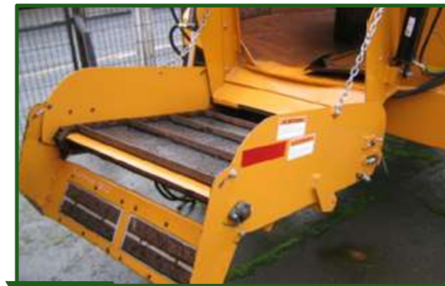
Figura 16-35 Sistema de descarga, de noria con barras y cadenas.
