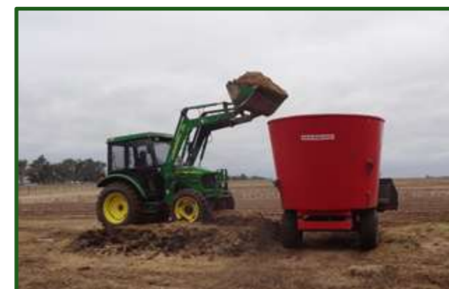
Figura 16-10 Los rodados 22.5" permiten una mejor transitabilidad en caminos en mal estado por ofrecer un mayor despeje, pero se debe evaluar siempre la altura a la cual se deberá realizar la carga, dado que también se incrementa la altura total del mixer.
