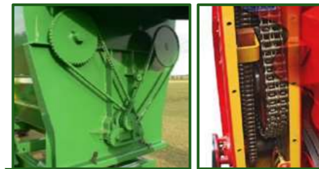
Figura 16-29 Vista de la reducción inicial (izquierda) y detalle de la reducción a cadenas, desde la parte posterior (derecha).
