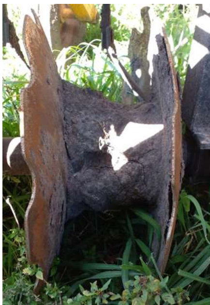
Foto 2. Adherencia de suelo a los discos de la rastra provocada por el exceso de humedad en el lote.
