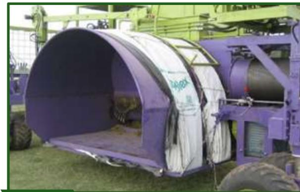
**Figura 14-26** Máquina con dos bolsas montadas en el túnel de compactación.
