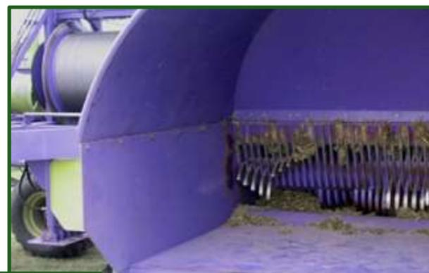
**Figura 14-24** Túnel de compactación de largo considerable, que permite incrementar la densidad del silo, con igual estiramiento de las bolsas.
