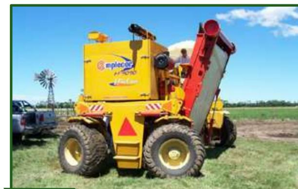
**Figura 14-28** Embolsadora autotransportable, con cuatro ruedas móviles y transmisión hidráulica en las mismas.
