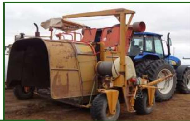
**Figura 14-25** Embolsadora con el túnel 70 cm más largo.
