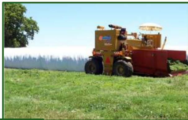
Figura 14-2 Confección de silos bolsa, sobre un manto de cobertura verde para preservar la base de la bolsa.
