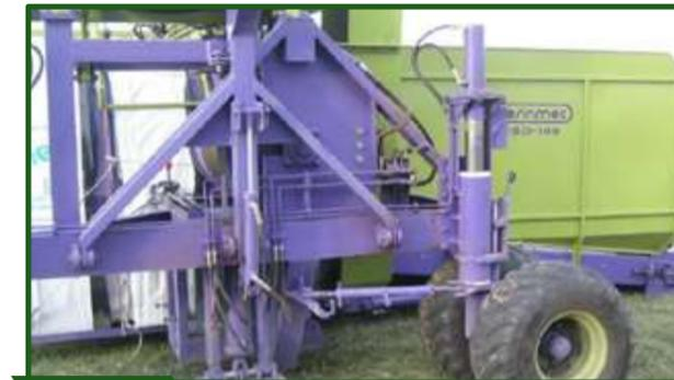
**Figura 14-29** Sistemas de levante hidráulico para el cambio de posición de transporte y trabajo de las ruedas de la máquina.
