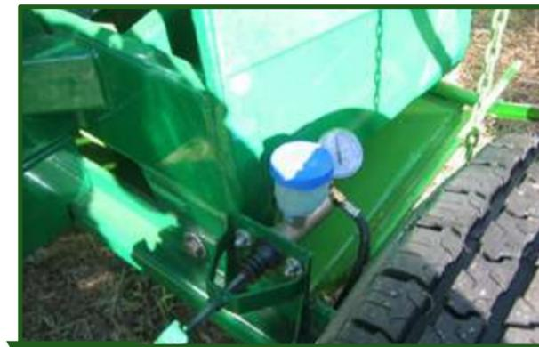
Figura 14-33 Regulación del freno hidráulico en las ruedas.
