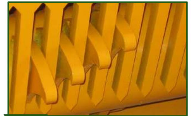
**Figura 14-16** Detalle de dientes con frente cambiable para mejorar y reducir costos en el servicio.
