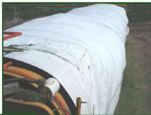
**Figura 14-10** Es importante observar la bolsa a la salida del túnel de compactación, para estimar el estiramiento de la bolsa.
