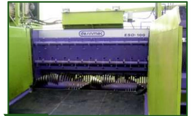
**Figura 14-15** Máquina con doble batidor de material para uniformar la carga.
