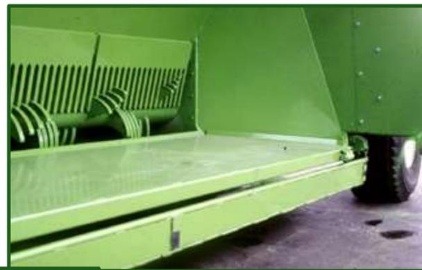
Figura 14-37 Sistema de doble fondo que facilita el vaciado del túnel, dentro de la bolsa.
