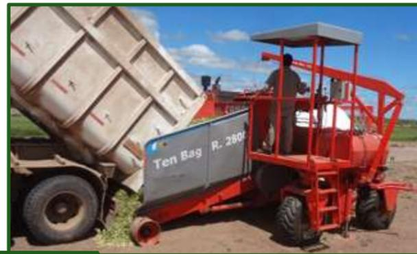
Figura 14-30 Embolsadora con el puesto de comando ubicado en el lateral opuesto al motor.
