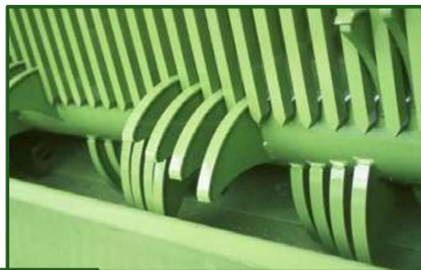
**Figura 14-20** Detalle de los álabes del rotor con el peine de alimentación al túnel de compactación.
