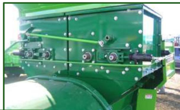
Figura 14-32 Sistema de ajuste de los rodillos quebradores de granos.
