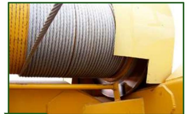
**Figura 14-17** Rotor con el cable de acero que se fija a la red para ejercer el "freno" de la máquina.
