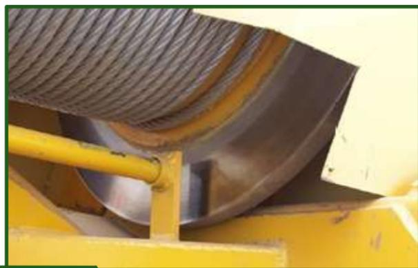
**Figura 14-18** Correcto mantenimiento de los discos de frenos.
