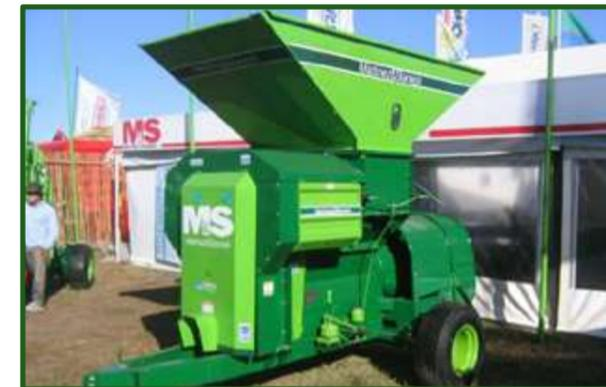
Figura 14-34 Embolsadora de grano húmedo, con tolva de recepción y sistema de freno en las ruedas.
