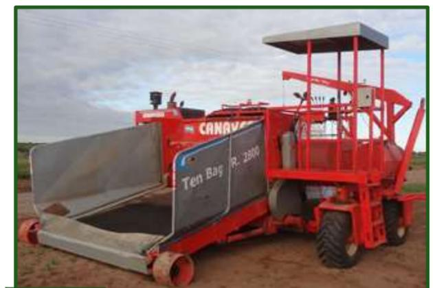
**Figura 14-14** Máquina con cinta continua que mejora la uniformidad de la carga.
