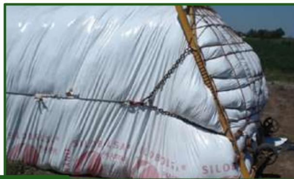
**Figura 14-23** Se observa la diferencia de largo de la rienda inferior que sujeta la red, para facilitar su posición al inicio de la bolsa, y su movimiento cuando se finaliza la confección de la misma.
