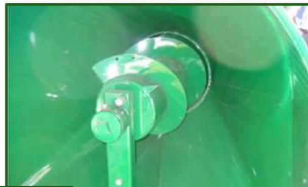
Figura 14-31 Sinfín de compactación dentro del túnel.
