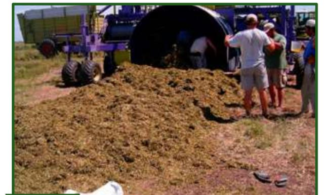
Figura 14-36 Vaciado del túnel de compactación.
