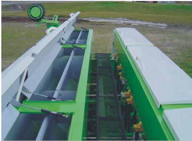
Tolvas con compartimientos interiores rebatibles para adecuar la capacidad de almacenamiento de cada insumo
