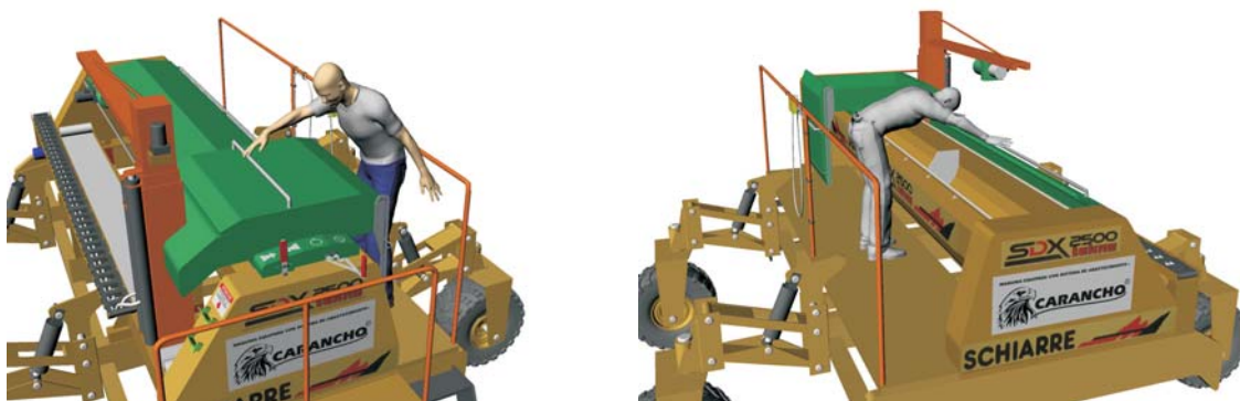
Apertura de la tolva y la batea recibidora para realizar el aprovisionamiento de insumos.
