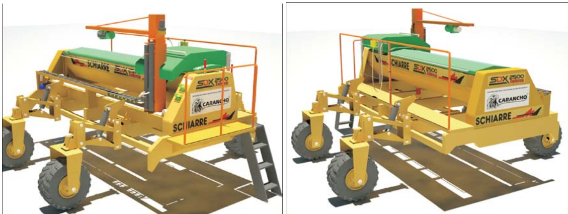
Vistas de la sembradora equipada con el sistema de aprovisionamiento de insumos diseñado.
