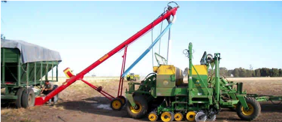
La pendiente del Sin Fin tiene impacto directo en la capacidad de elevación y en el daño mecánico que le provoca al material movilizado.
