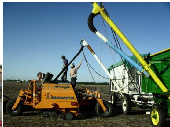
Los carros graneleros equipados con Sin Fin hidráulico han cobrado gran difusión entre el parque de maquinas destinadas al abastecimiento de sembradoras y fertilizadoras.
