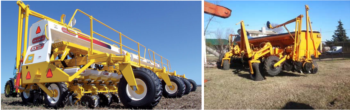
Sembradoras monotolva auto trasportadas comúnmente conocidas como "tiro de punta". Izq: posición de trabajo; Der: posición de transporte.
