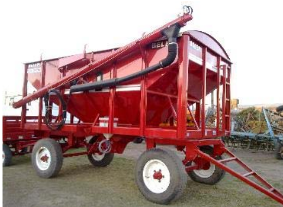
Los carros graneleros equipados con Sin Fin hidráulico han cobrado gran difusión entre el parque de maquinas destinadas al abastecimiento de sembradoras y fertilizadoras.
