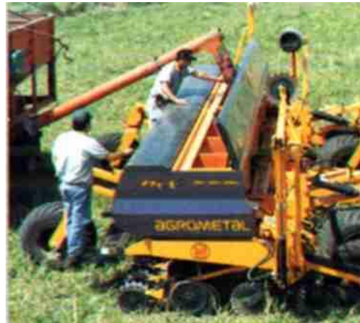
Tolvas con compartimientos interiores rebatibles para adecuar la capacidad de almacenamiento de cada insumo
