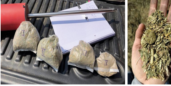
■ Figura 33. Manipulación de las submuestras para la conformación de la muestra compuesta.
