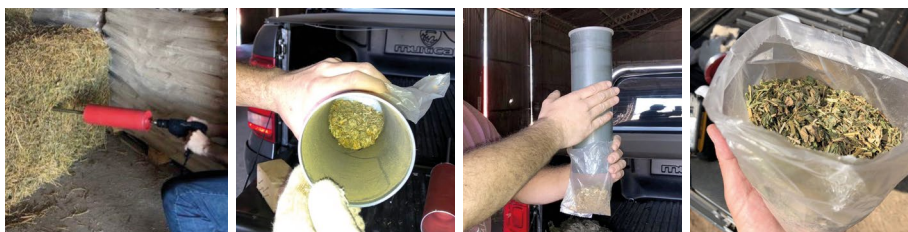
■ Figura 36. Empaquetado correcto de las muestras para su envío al laboratorio.
