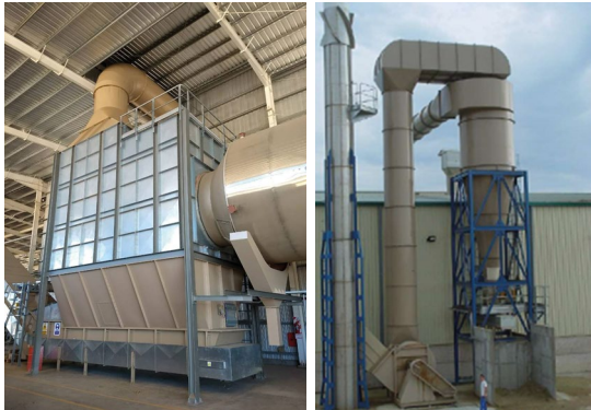
■ Figura 18. Módulo de decantado de partículas (izquierda) y separador de materiales finos y polvo (derecha). Foto: gentileza Apisa S. L., España.
