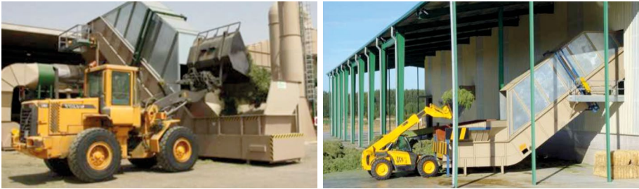
■ Figura 15. Carga del material en la boca de recepción del tromel de secado. Foto: gentileza de Apisa S. L., España.
