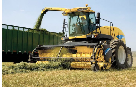
■ Figura 3. Recolección de alfalfa preoreada en campo para su traslado a planta de procesado a través de una picadora con recolector pick-up sobre camión (izquierda) o sobre carro forrajero (derecha). Fotos: gentileza de las empresas Claas y New Holland.
