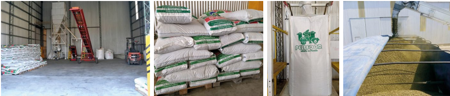
■ Figura 9. Módulo de empaquetado (izquierda), donde los pellets se envasan para su comercialización en bolsas de 25 o 40 kg (centro-izquierda) o en big bags de 1 a 1,5 t (centro-derecha). Otra opción es el transporte a granel en camiones (derecha). Fuente: Pellfood S. A.
