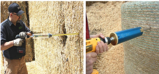
■ Figura 35. Forma correcta de insertar el muestreador en megafardos (izquierda) y rollos (derecha).
