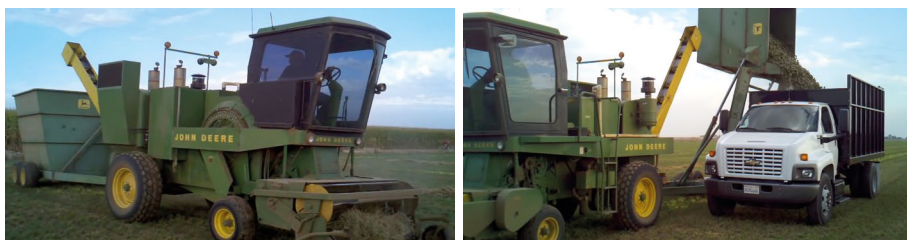
■ Figura 10. Cubeteadora autopropulsada John Deere 425 Cuber difundida en los Estados Unidos en la década de 1970.
