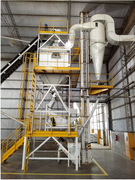
■ Figura 8. En el módulo de enfriado los pellets alcanzan la temperatura ambiente y son zarandeados para separar el material no pelletizado. Seguidamente, los pellets son conducidos hacia el módulo de empaque o de descarga a granel. Fuente: Pellfood S. A.
