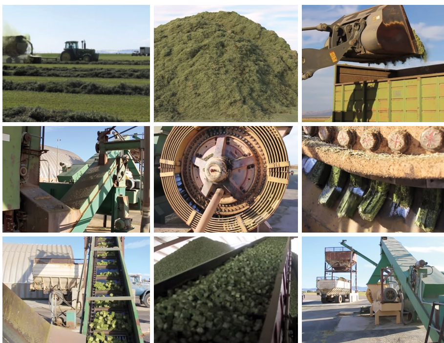
■ Figura 11. Confección de cubos de alfalfa en planta de la firma James Farm Inc. (Estados Unidos). El proceso incluye desde la recolección del material henificado en el campo (arriba-izquierda) hasta la carga a granel en un camión para su transporte y comercialización (abajo-derecha).
