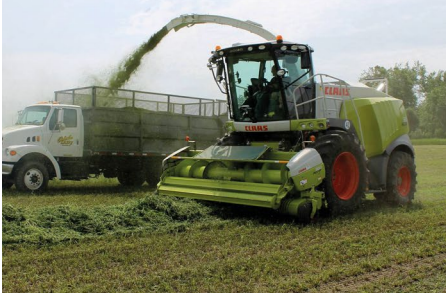
■ Figura 3. Recolección de alfalfa preoreada en campo para su traslado a planta de procesado a través de una picadora con recolector pick-up sobre camión (izquierda) o sobre carro forrajero (derecha). Fotos: gentileza de las empresas Claas y New Holland.
