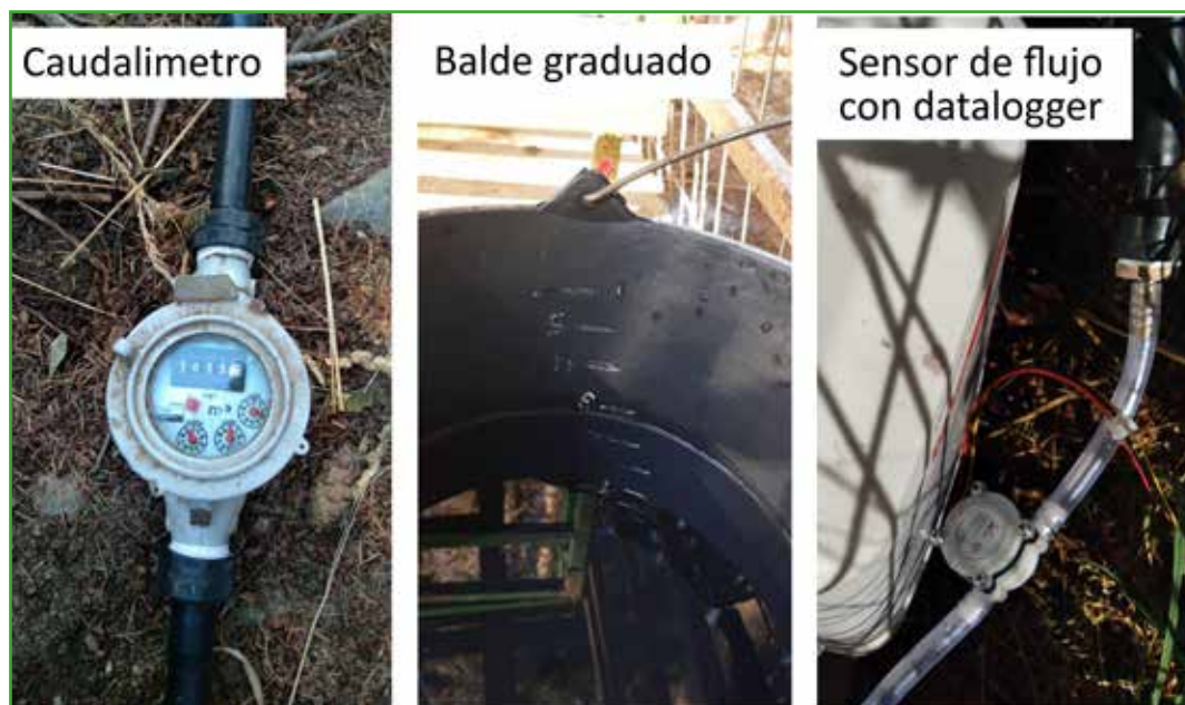
Figura 2: Sistemas de medición para el relevamiento del consumo de agua.
