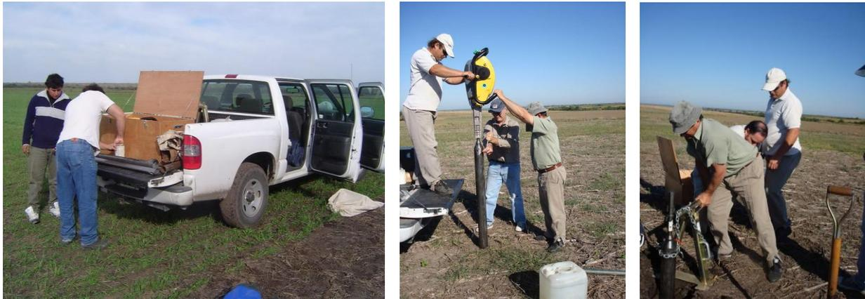
**Figura 1:** Presentación a campo del muestreador columnar de suelos y extracción de la muestra.
