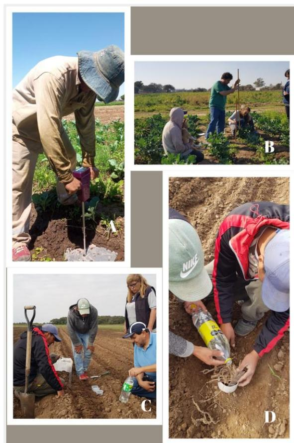
**Figura 5: Prácticas de medición de fertilidad física de los suelos con productores. A y B: medición de la resistencia a la penetración mediante penetrómetro digital (A) y penetrómetro manual (B). C: determinación de estabilidad estructural. D: Determinación de capacidad de infiltración (CI) del suelo.**
