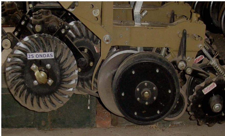
Figura 3: Cuerpo de siembra alistado con la cuchilla Turbo de 25 ondas
