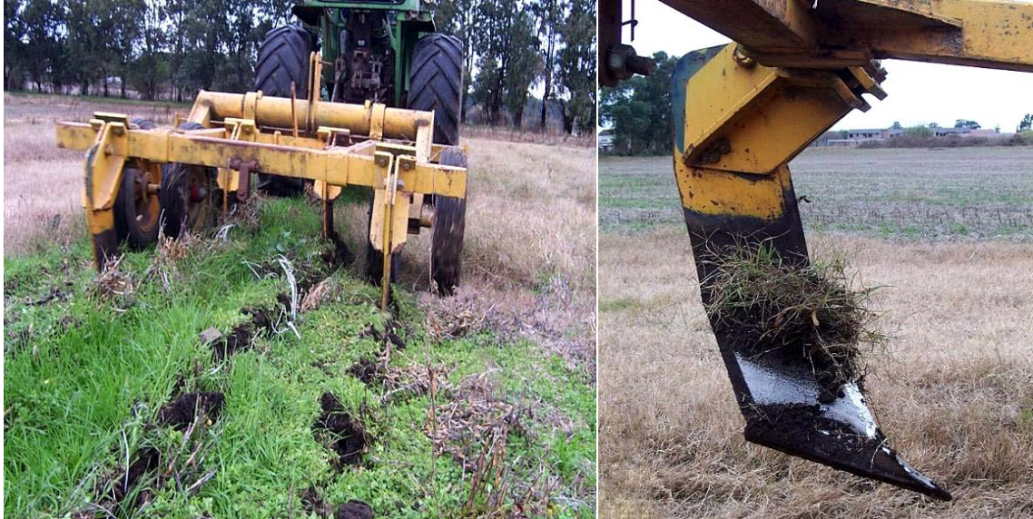
Figura 1: Izquierda: Escarificado del suelo con cultivie. Derecha: Detalle de la púa (órgano activo de la herramienta)
