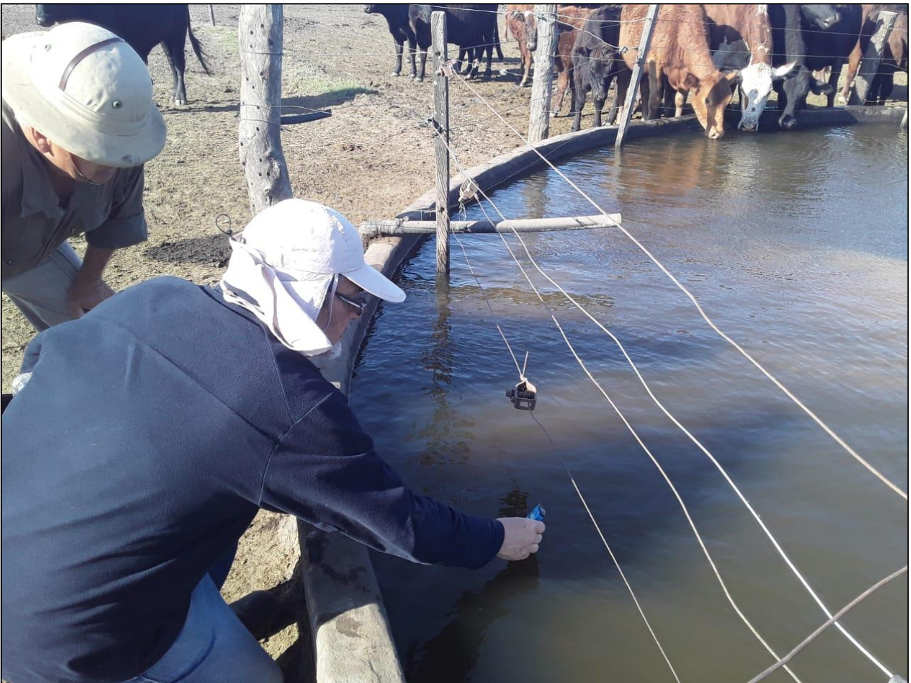
Midiendo la conductividad eléctrica del agua del tanque bebedero con un conductímetro HANNA Serie Dist 4 ante la atenta mirada de Luciano Quintana.
