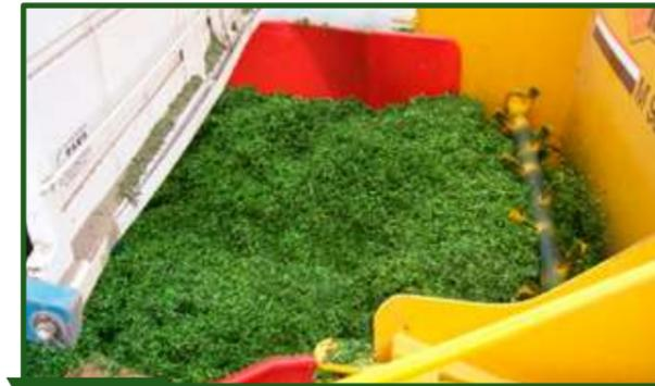
Figura 11-26 El rotor superior ayuda a ir "enrazando" el material en la bandeja de descarga.
