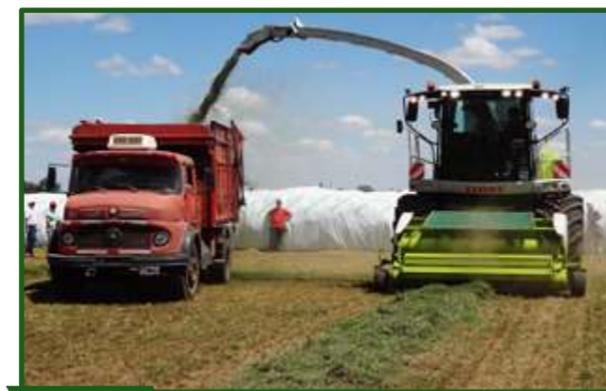
Figura 11-8 La forma correcta de realizar un silaje de alfalfa es realizando el corte de la pastura, preoreado y luego recolectado con la picadora equipada con el pick-up.
