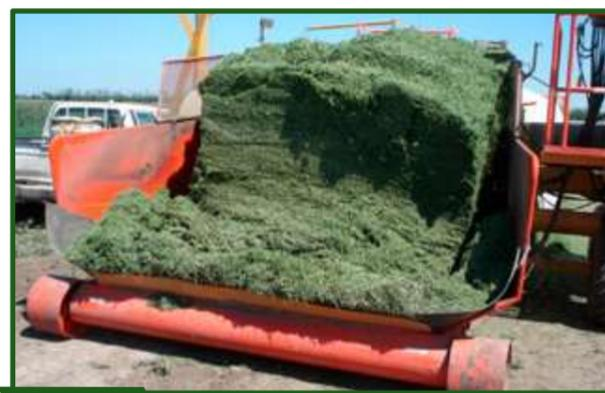
**Figura 11-13** Cuando se observa que quedan formadas paredes en material descargado, se puede estimar que se está trabajando en el rango de humedad adecuado.
