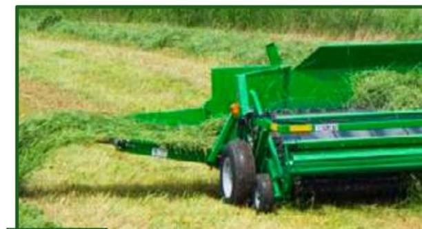
**Figura 11-22** Merger o agrupador de hileras que favorecen el trabajo rápido y limpio en la confección de hileras de gran porte.
