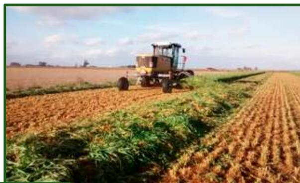
**Figura 11-18** Actualmente se dispone de equipos autopropulsados que trabajan con pilotos automáticos con señal correctora RTK y permite hacer un triple andanado. El primer paso es abrir una melga tirando el material cortado al medio (arriba) y luego realizar dos pasadas paralelas a esta primera pero con el desplazador activado, para arrojar el pasto sobre hilera (abajo).
