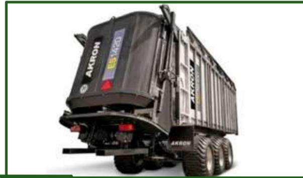
Figura 11-24 Los acoplados con sistemas de precompactación, ayudan no solo en el traslado más eficiente del material del campo a la estructura de almacenaje, sino que además agilizan la descarga del forraje.
