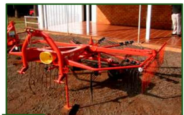
**Figura 11-21** Los rastrillos giroscópicos representan una herramienta muy útil al momento de juntar hileras en la confección de silos de pasturas.
