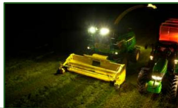
**Figura 11-20** Cabezales de gran ancho que evitan el uso excesivo de los rastrillos, para lograr volumen de carga en las picadoras, facilitando el largo de corte consistente.
