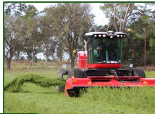
**Figura 11-19** Segadora autopropulsada con sistema triple hilerador (15 m de ancho de corte en una sola andana).
