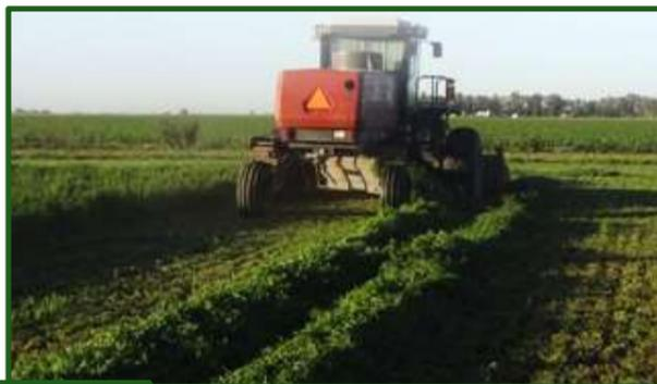
**Figura 11-17** Sistema de agrupadores de andanas adosados a las cortadoras, que juntan dos hileras sin necesidad de usar rastrillos, mejorando la higiene del forraje.
