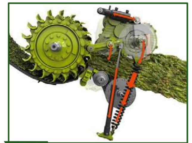
**Figura 11-16** Para que las cuchillas del rotor picador realicen un corte neto y parejo contra la contracuchilla, es necesario que los rodillos alimentadores entreguen una buena cantidad de forraje.
