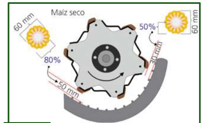
Figura 10-64 Luz de entrada y salida entre cilindro y cóncavo transversal con maíz seco.
