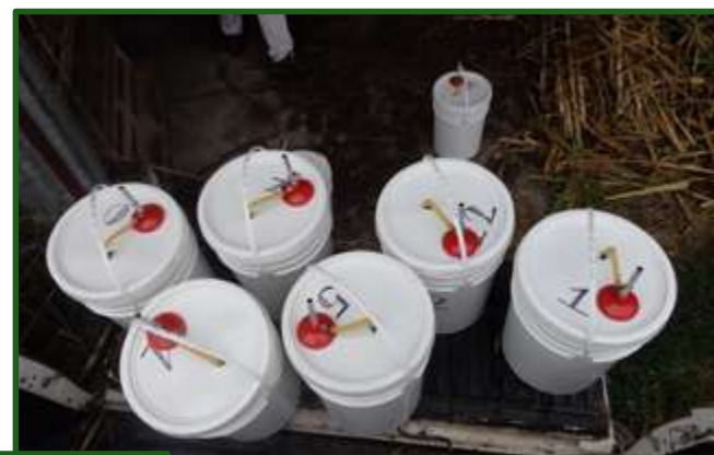
Figura 10-73 Silos experimentales de caña de azúcar, de 20 litros de capacidad cada uno, sellados y con la válvula para la liberación de gases colocada en la tapa, previos a ser transportados a laboratorio para su conservación. Fuente: (Peiretti and Navarro, 2018).
