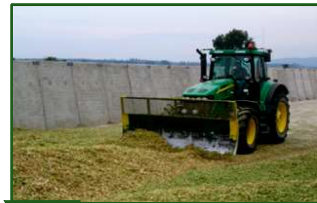
Figura 10-32 Los equipos con caja inversora permiten el trabajo en avance y retroceso haciendo el compactado más eficiente.
