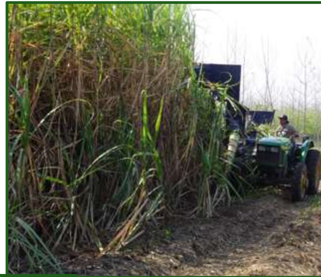
Figura 10-70 Para el uso de picadoras de arrastre, debemos considerar utilizar un tractor con marcha ultra lenta para poder trabajar correctamente frente al alto volumen del cañaveral.
