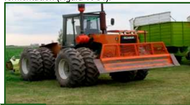
Figura 10-29 Tractor muy utilizado para la compactación de los silos aéreos.
