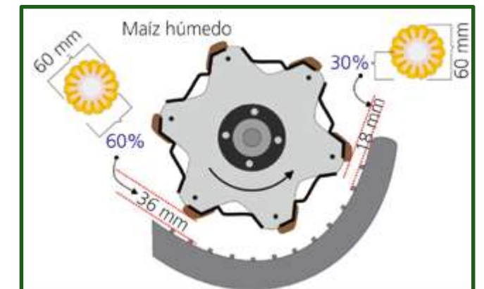
Figura 10-65 Luz de entrada y salida entre cilindro y cóncavo transversal con maíz húmedo.
