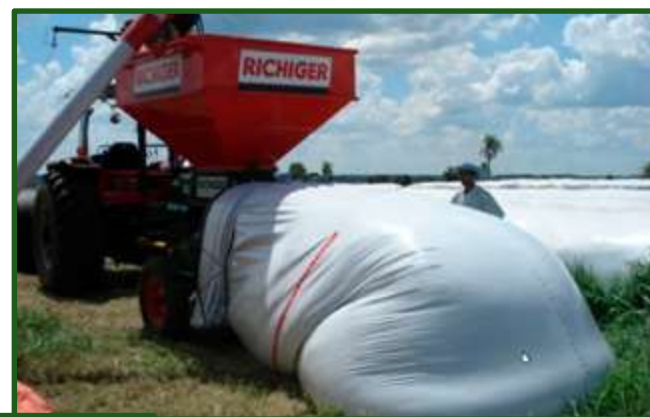
Figura 10-57 Inicio de la bolsa con mínima presión para asegurar la confección y vida útil de la bolsa
