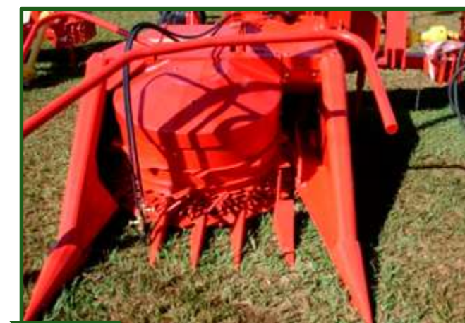
Figura 10-28 Cabezal rotativo de una máquina de arrastre.
