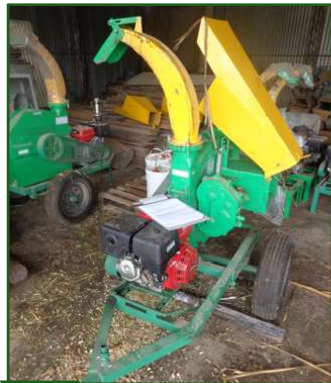
Figura 10-70 Picadora JF 60 maximum utilizada para picar caña de azúcar en el ensayo de (Peiretti and Navarro, 2018).
