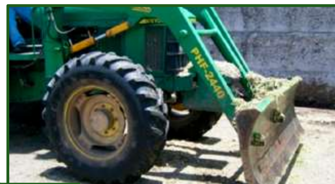
Figura 10-30 Si se pone un tope en los hidráulicos del sistema de desparramado, se facilita la operación del mismo evitando bajarlo a menos de 10 cm.
