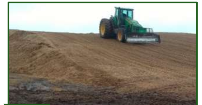
Figura 10-44 Forma de trabajo correcta para el compactado, en un plano inclinado de poco ángulo y permitiendo que el tractor no baje de la estructura de almacenaje
