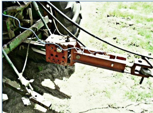
**Figura 4:** Celda de carga electrónica intercalada entre el tractor y la máquina evaluada.
