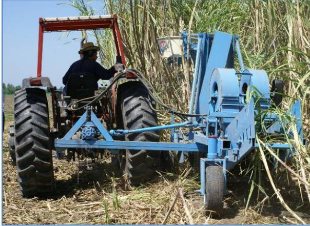
**Figura 2:** Máquina utilizada en la cosecha reducida. Peso aproximado 2.500 kg.
