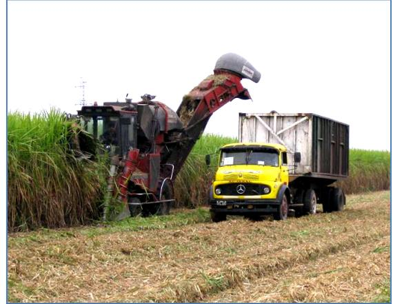
**Figura 3:** Máquina utilizada en la cosecha convencional. Peso aproximado 12.000 kg.
