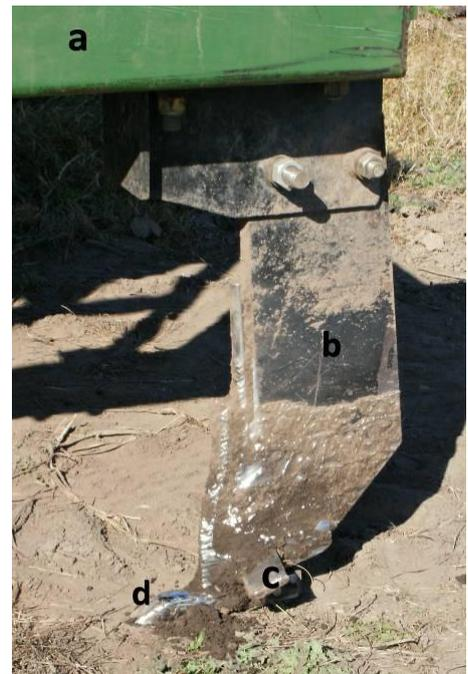
**FIGURA 2.1.5:** Detalle: a: bastidor; b: timón; c: alas; d: púa
