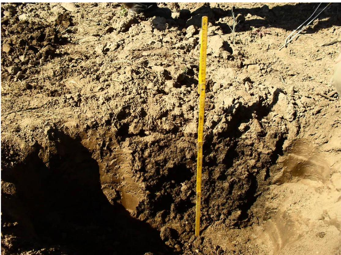
**Figura 3.3.5.2:** Corte de suelo perpendicular a la labranza en franjas. Puede visualizarse los sectores alterados y sin alterar. Julio de 2013.
