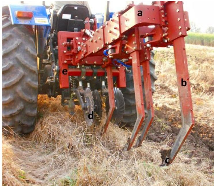
**Figura 2.1.6:** Vista trasera en posición de transporte del prototipo. Referencias: a: Bastidor; b: Timón; c: Púa (órgano activo); d: cuchilla de corte; e: Torre de acoplamiento.
