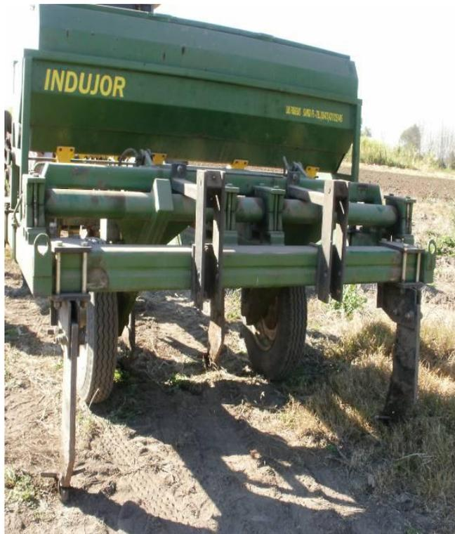
**FIGURA 2.1.3:** Vista posterior del subsolador
