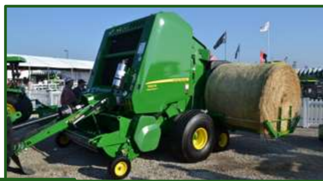
Figura 9-8 Transportador de rollos montado en la misma rotoenfardadora John Deere presentado en Farm Progress Show 2017 de EEUU
