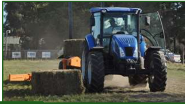
Figura 9-6 Transportador de megafardos Agromec REM 12/15, apto para recolectar y estibar hasta 12 unidades de 2.500x700x1.200 mm (o 15 fardos de 2.500x800x880 mm). Ofrece una capacidad de carga total de 8 t y sistema hidráulico con electroválvulas y sensores para su operación automatizada.
