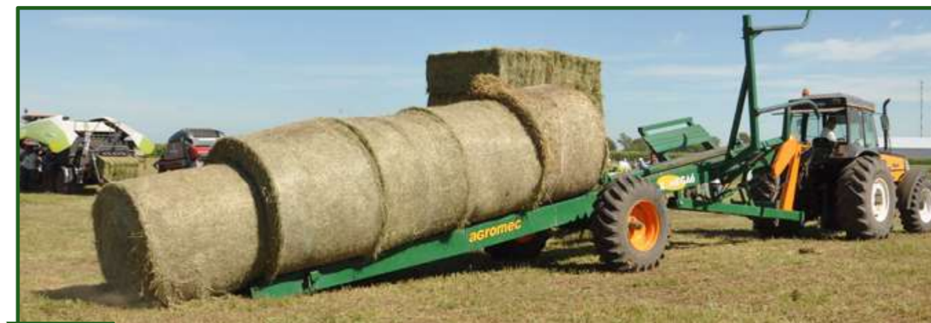
Figura 9-5a Transportador de rollos con capacidad de carga para seis rollos y accionamiento hidráulico integral.
