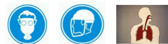
Figura 11. Señales de obligatoriedad de uso de diferentes máscaras protectores (en azul) y advertencia de riesgos en vías respiratorias
