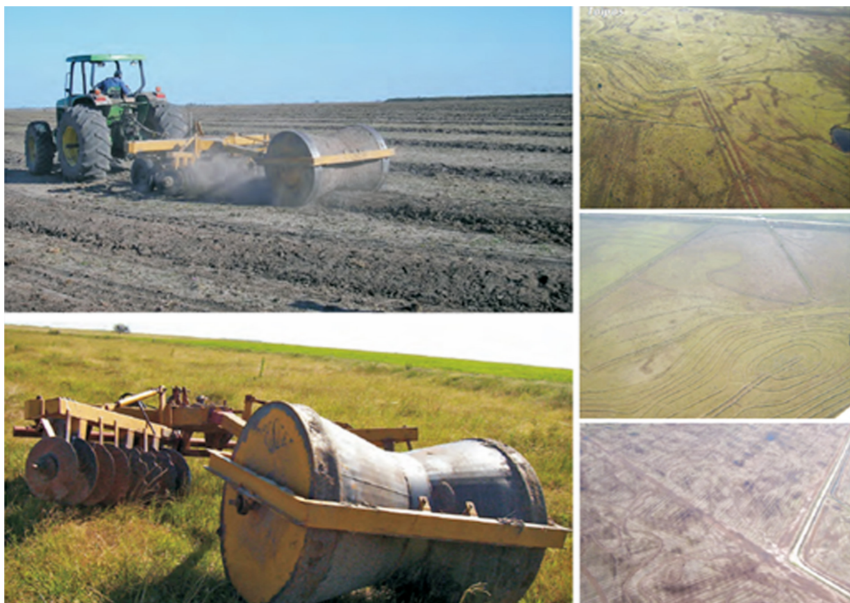
Figura 23. Construcción de taipas con rastra taipedadora.
