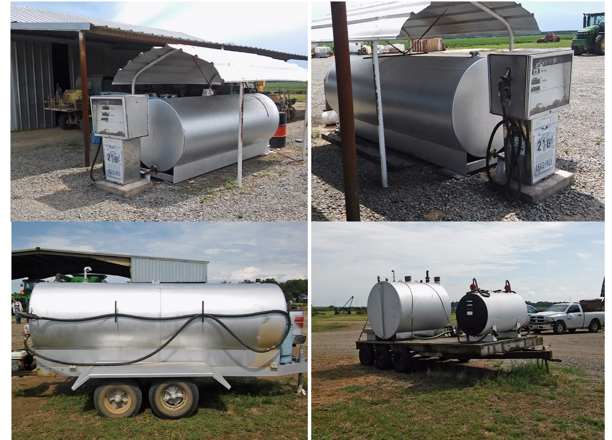
Figura 44. Formas seguras de almacenamiento y transporte seguro de combustibles
