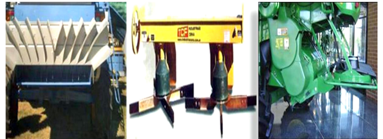
Figura 42. Tipos de esparcidores-desparramadores de paja. a) Desparramador deflector; b) Desparramador centrífugo de caucho; c) Desparramador centrífugo metálico
