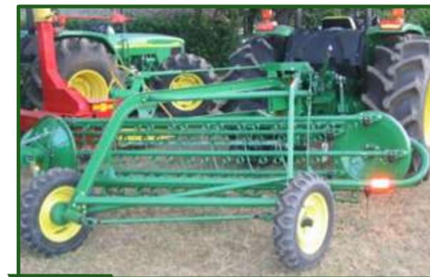
**Figura 7-13** Rastrillo de barras paralelas y molinetes oblicuos, con accionamiento mediante cardán a la rueda del mismo.
