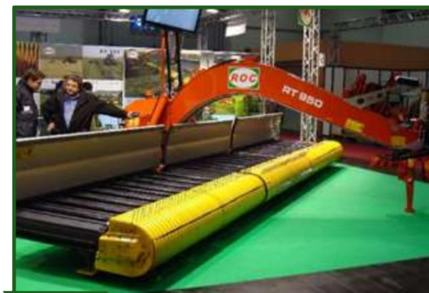
**Figura 7-14** Invertidor de andana de forraje ROC de 9,5 metros de ancho. Aluminio, caucho, plástico, polímeros, hidráulico, sistema electrónico; todo un equipo de alta tecnología al servicio del forraje conservado.
