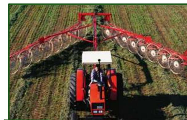
**Figura 7-7** Rastrillo de arrastre con diseño de ruedas en "V".
