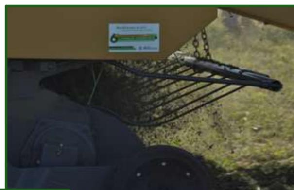
**Figura 7-2** Pérdida excesiva por recolección cuando se trabaja con hileras de baja densidad
