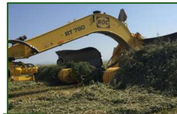
**Figura 7-15** Invertidor de andana en pleno trabajo. Si bien para la confección de heno puede resultar de un costo excesivo, para el trabajo con silaje de pasturas en zonas de campo con piedra, reducen mucho el riesgo de rotura de las picadoras.
