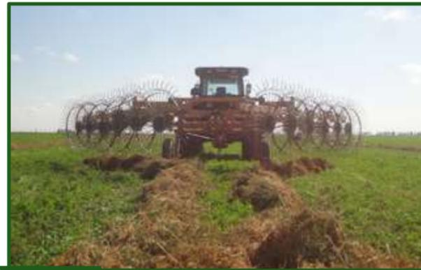
Figura 7-20 Gavilla mal confeccionada por falta de velocidad en rastrillado, que deriva en un rollo con forma de reloj de arena.
