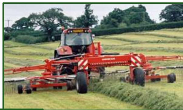
**Figura 7-11** Rastrillo giroscópico con una correcta regulación en la formación de las hileras. Los modelos de 4 rotores están destinados fundamentalmente a la confección de silajes
