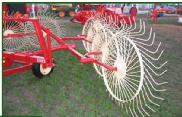
**Figura 7-8** Rastrillo estelar (en "V") con diseño de ruedas montadas sobre balancín.
