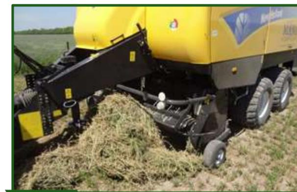
**Figura 7-19** Gavilla confeccionada con más de 40 % de humedad con formación de bollos que dificultan la alimentación de las máquinas.
