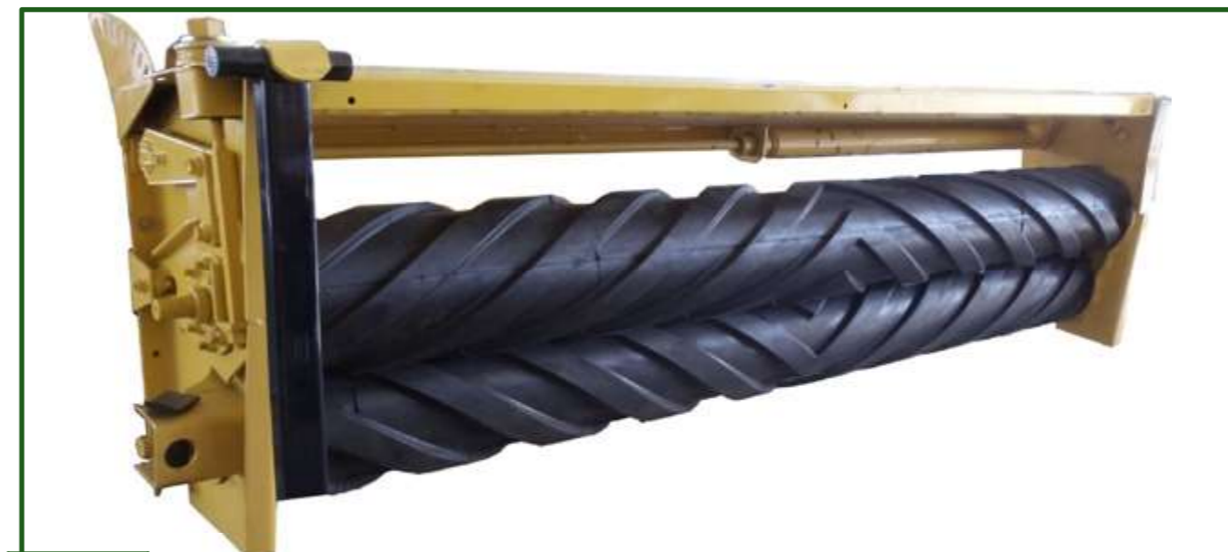
Figura 6-46 Acondicionadores de rodillos de goma tipo chevron.
