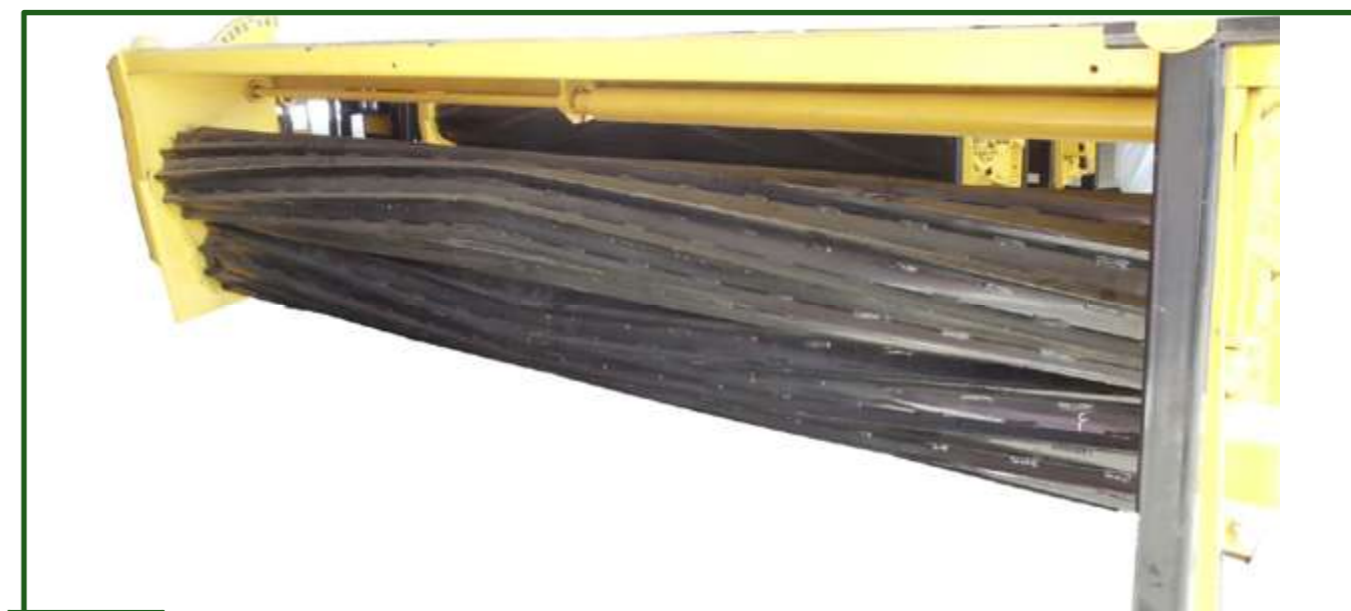
Figura 6-45 Acondicionadores de rodillos metálicos. La presión ejercida por los rodillos (intensidad) es variable y su ajuste se realiza mediante un tornillo que los acerca o aleja, dependiendo del volumen del material cortado y la velocidad de avance.
