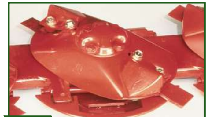
Figura 6-22 Plataforma de corte de secciones independientes. El diseño modular permite reducir los tiempos y costos de reparación, dado que se tiene repuestos en común para cada disco. Los niveles de aceites son independientes.
