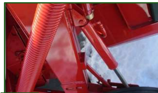
Figura 6-20 Sistema de flotación del cabezal de corte mediante dos resortes que se ajustan a través de un tornillo. Aumentar el peso para campos más lisos y velocidades más rápidas y disminuir el peso en terrenos más suaves y velocidades bajas.
