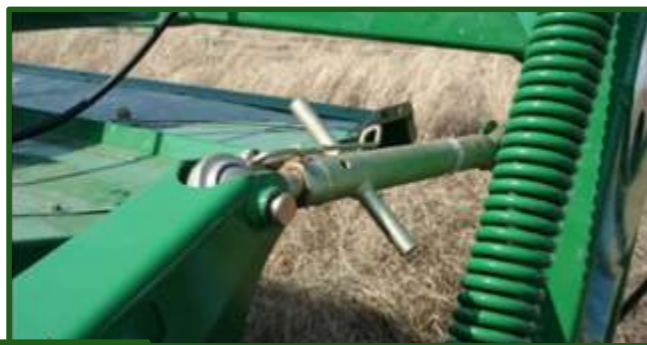
Figura 6-25 Dispositivo de doble rosca para regular la inclinación del ángulo de corte.
