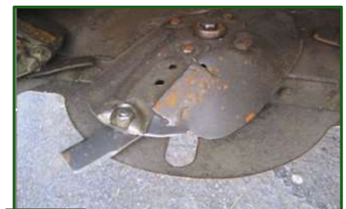
Figura 6-21 Refuerzo soldado en un disco de corte. Esta es una práctica perjudicial para la vida útil de la máquina (desbalanceo perjudicial para la vida útil del sistema de mando).
