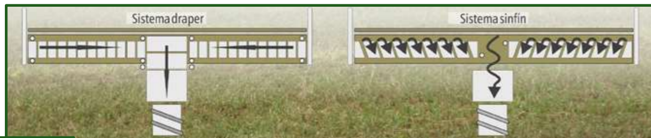
Figura 6-6 Esquema de cabezal draper y de cabezal convencional a sinfin
