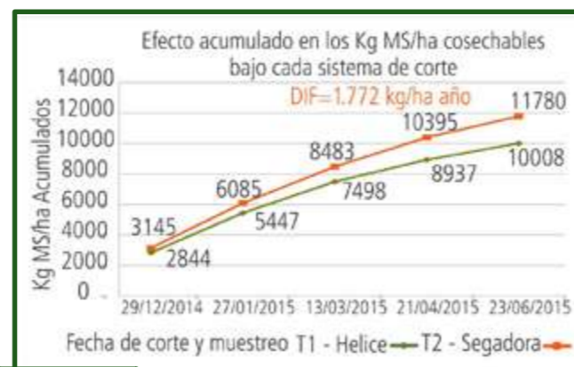
Figura 6-36 Curvas de la diferencia acumulada en el rendimiento de la pastura, teniendo en cuenta las pérdidas por repicado y por la disminución en el rendimiento.
