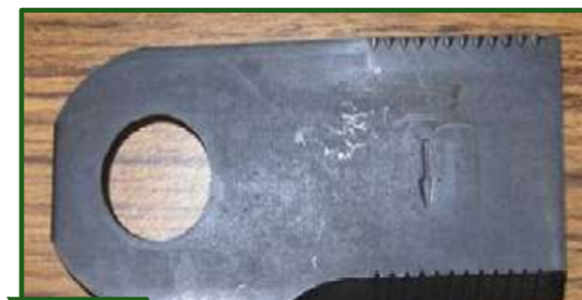
Figura 6-16 Detalle de cuchillas aserradas reversibles de 14 grados. El aserrado canaliza las partículas de fricción y reduce el desgaste sobre las cuchillas. Incrementa la vida útil en suelos arenosos o abrasivos.
