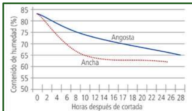
Figura 6-26 Efecto del ancho de la andana en la velocidad del secado de la alfalfa.
