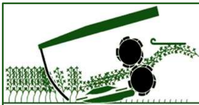
Figura 6-48 Esquema de trabajo de un sistema de acondicionamiento mediante rodillos.
