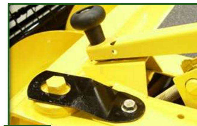
Figura 6-53 Tornillo simple en cada lado del rodillo, que permite ajustar la separación debida al desgaste normal.
