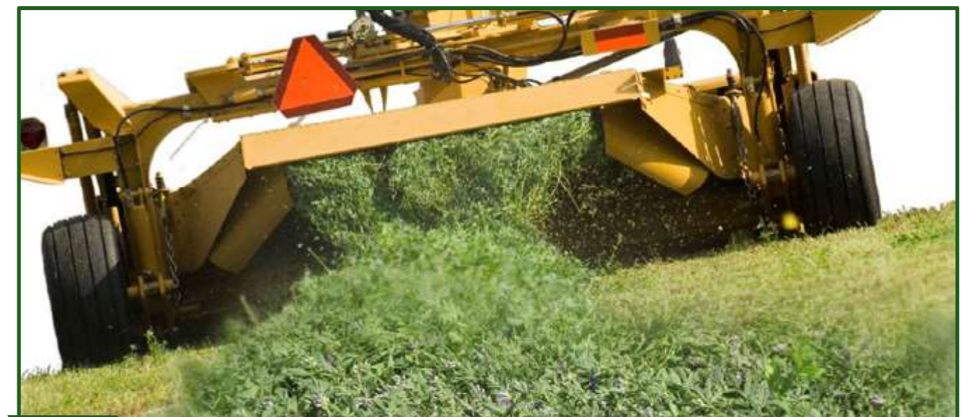
Figura 6-27 Regulación posterior de los deflectores formadores de andanas.
