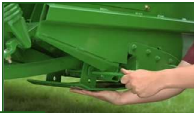
Figura 6-24 Patín de copiado lateral de fácil regulación.
