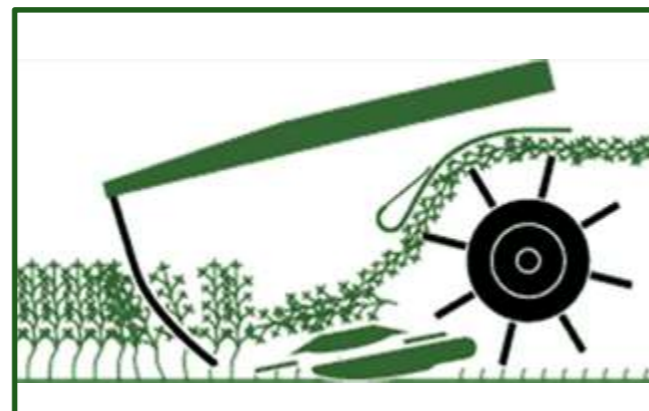
Figura 6-55 Esquema de trabajo de un acondicionador de dedos o impeller.
