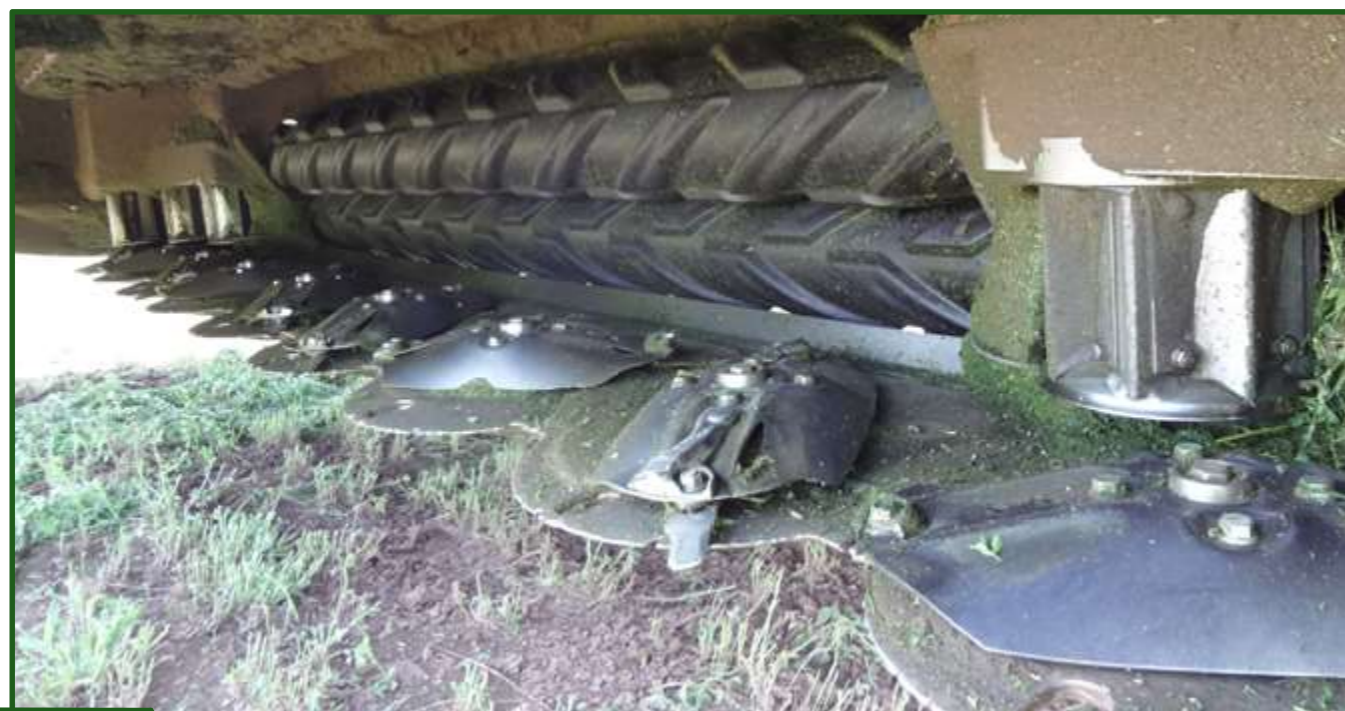
Figura 6-39 Acondicionador mecánico: es importante acortar el tiempo de respiración debido a que se trata de un proceso de oxidación perjudicial.
