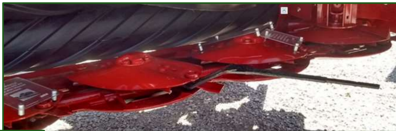
Figura 6-18 Sistema de fácil reemplazo de cuchillas.
