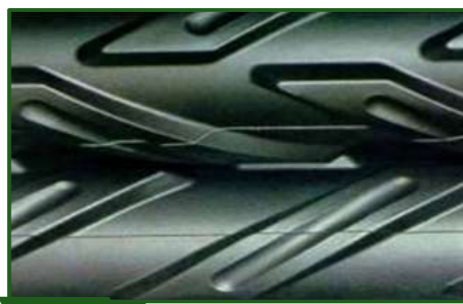
Figura 6-50 Detalle del diseño de los tacos de un rodillo acondicionador.
