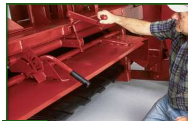
Figura 6-52 Manivela de ajuste de la presión del rolo de acondicionamiento, aplica una fuerza consistente para acondicionar el cultivo.
