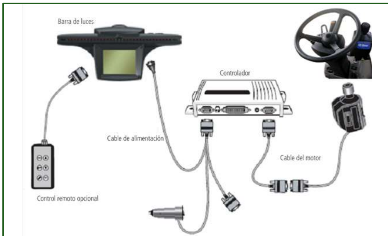
Figura 6-30 Componentes del piloto automático, montados sobre el volante de la máquina
