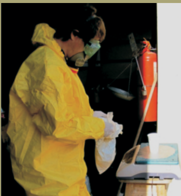
Figura 8. Operario pesando Dazomet en balanza electrónica, utilizando equipo completo de protección personal.
