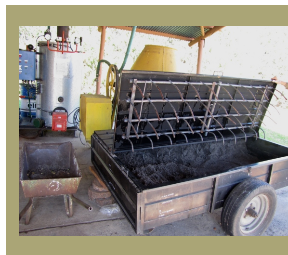
Figura 11. Equipo generador de vapor para desinfección de suelo y sustratos. Se observa en primer plano el cajón donde se coloca la mezcla a desinfectar, en cuya tapa se ubican los caños perforados por donde se inyecta el vapor. Al fondo se observan la caldera y la mezcladora de sustrato (Foto tomada en el Centro Único de Introducción y Saneamiento de la EEA Concordia de INTA, Entre Ríos).
