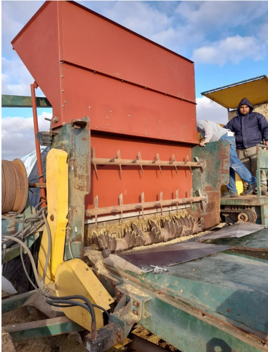
Foto 1: Tolva de descarga ajustable, montada sobre el rotor de empaquetado de embolsadora de 9 pies. Prototipo utilizado para la confección del tratamiento de autoconsumo de ración ensilada (ARE).
