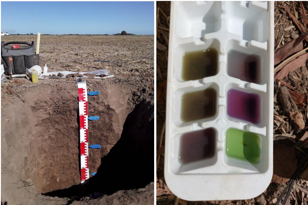
Figura 21. Delimitación de horizontes en pozo de exploración (izquierda) y de pH por método colorimétrico (derecha).
