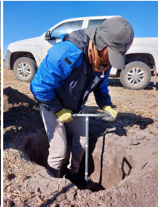
Figura 20. Determinación de color con tabla Munsell (izquierda) y de profundidad de zona saturada con barreno (derecha).
